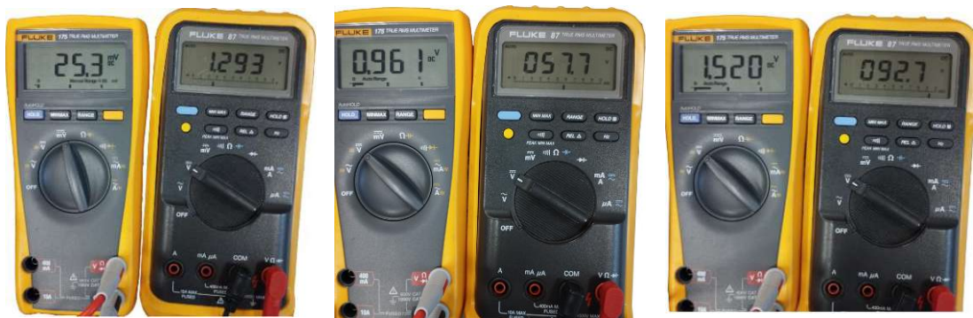
Abbildung 32: Messung der realen Größen und Größen am Eingang des ADCs
