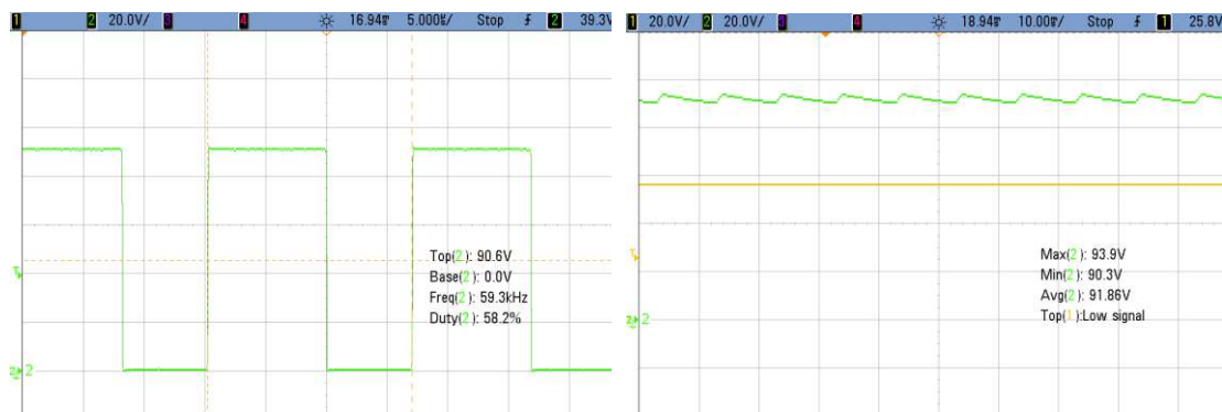
Abbildung 35: Signale des Hochsetzstellers bei 500W/m 2 Einstrahlung
