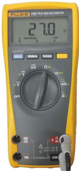
Abbildung 30: Widerstandsmessung der Heizspirale bei einem Wasserkocher
