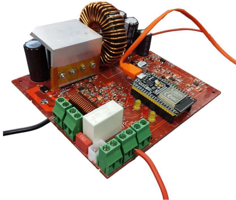
Abbildung 23: Die Leiterplatte nach der Bestückung - ISO Ansicht
