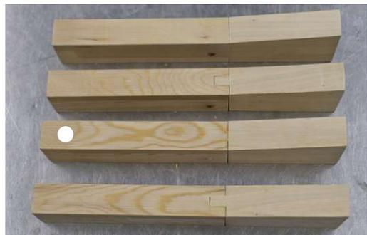
Abb. 100 Liniengrafik - 6 V2 Stab Halbverdeckter Schlitz und Zapfen
