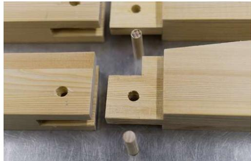
Vergleich der oberen Ansicht der Verbindungskante der Proben 6.V1 bis 6.V4
