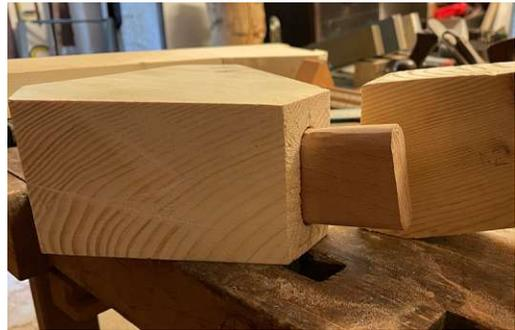
Durch die versteckte Montage sind schlussendlich nur die Sicherungsdübel von Außen erkennbar, was zu einem reduzierten Erscheinungsbild der Verbindung führt.
