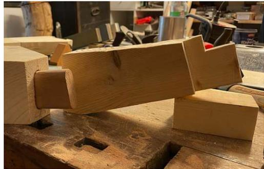
Geöffnete Verbindung der Probe 6 welche im geschlossenen Zustand durch den Buchendübel in der Lage gehalten wird.
