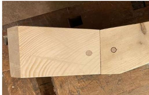
Scherversuch zwischen Knotenpunkt und Mittelsegment am 26.08.2021
