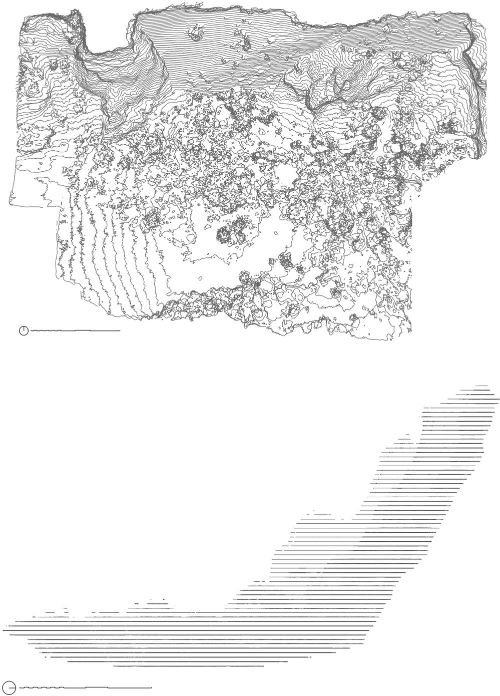
Abb. 175 Höhenlinien aus der Punktwolke im Grundriss - Digitales Arbeitsmodell
