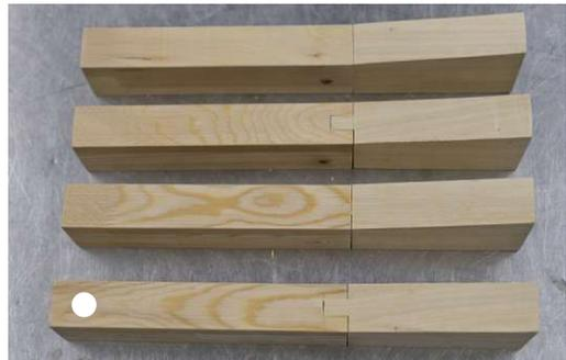
Abb. 92 Liniengrafik - 6 V1 Stab Halbverdeckter Schlitz und Zapfen
