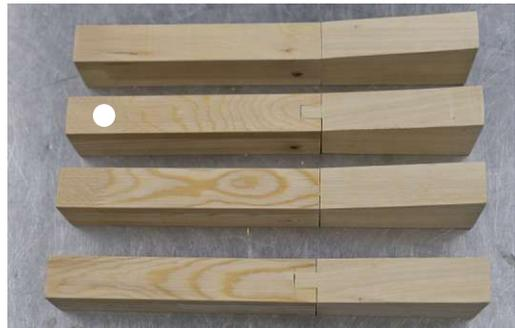
Abb. 108 Liniengrafik - 6 V3 Stab Halbverdeckter Schlitz und Zapfen
