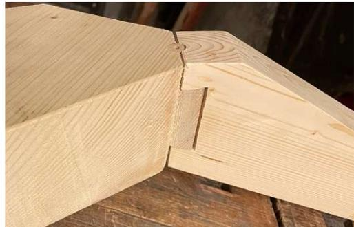
Scherversuch zwischen Knotenpunkt und Mittelsegment am 26.08.2021
