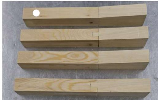
Abb. 116 Liniengrafik - 6 V4 Stab Halbverdeckter Schlitz und Zapfen
