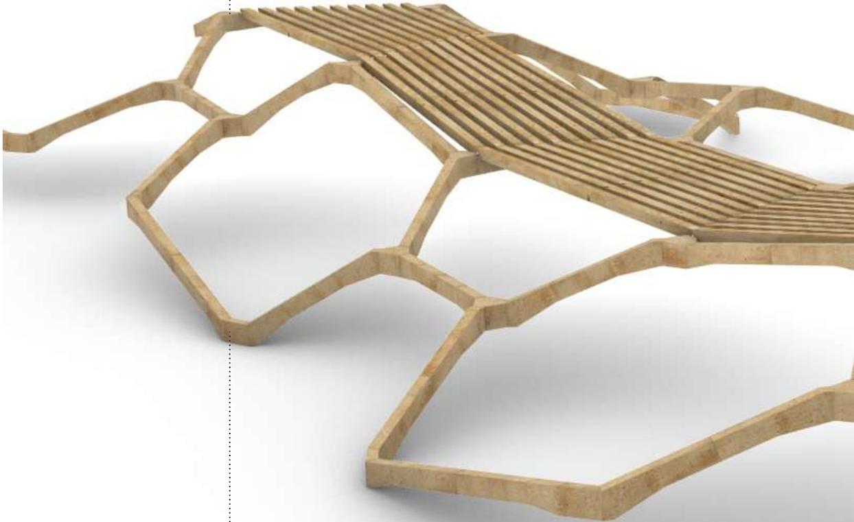
KNOTENPUNKTE AN DEN TIEFPUNKTEN ÜBERNEHMEN DIE LASTABTRAGENDE FUNKTION IN DEN BODEN UND WERDEN JE NACH UNTERGRUND AN EINZEL-/SCHRAUBFUNDAMENTEN BEFESTIGT
