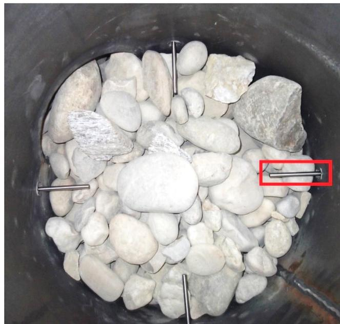
Abb. 5.2: Einbaulage der Thermolemente einer Messebene anhand einer groben Schüttung dargestellt (Drainageschotter), Quelle: [36]
