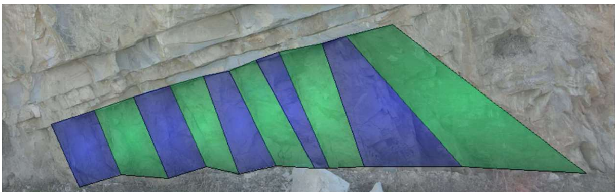
Abb. 7.8: Abwechselndes Bruchflächenbild der Trennflächenscharen Nordost-Südwest (grün) und Nord (blau)
