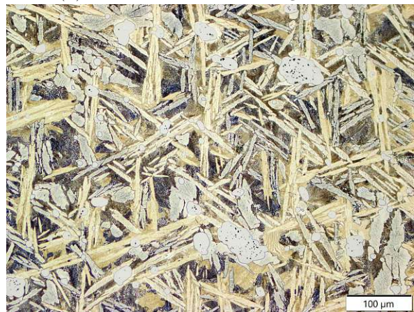
(d) Ti-6.5Cu+3vol% TiC 1000 °C/90h perpendicular
