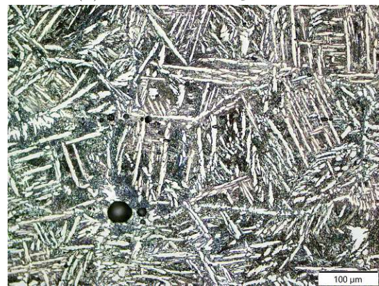
(d) Ti-6.4Ni-2Fe 1000 °C/90h perpendicular
