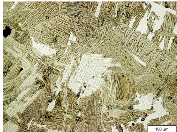
(d) Ti 1000 °C/90h perpendicular
