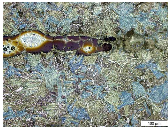
(b) Ti-6.4Ni-2Fe longitudinal
