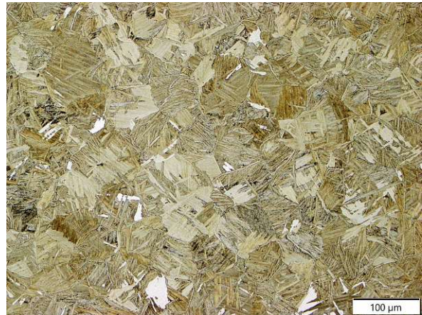
(b) Ti-6Al-4V longitudinal
