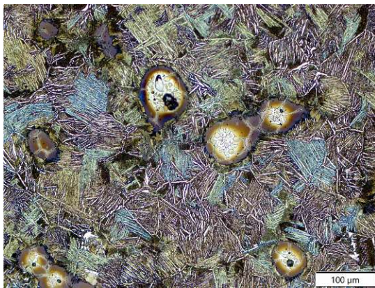
(a) Ti-6.4Ni-2Fe perpendicular
