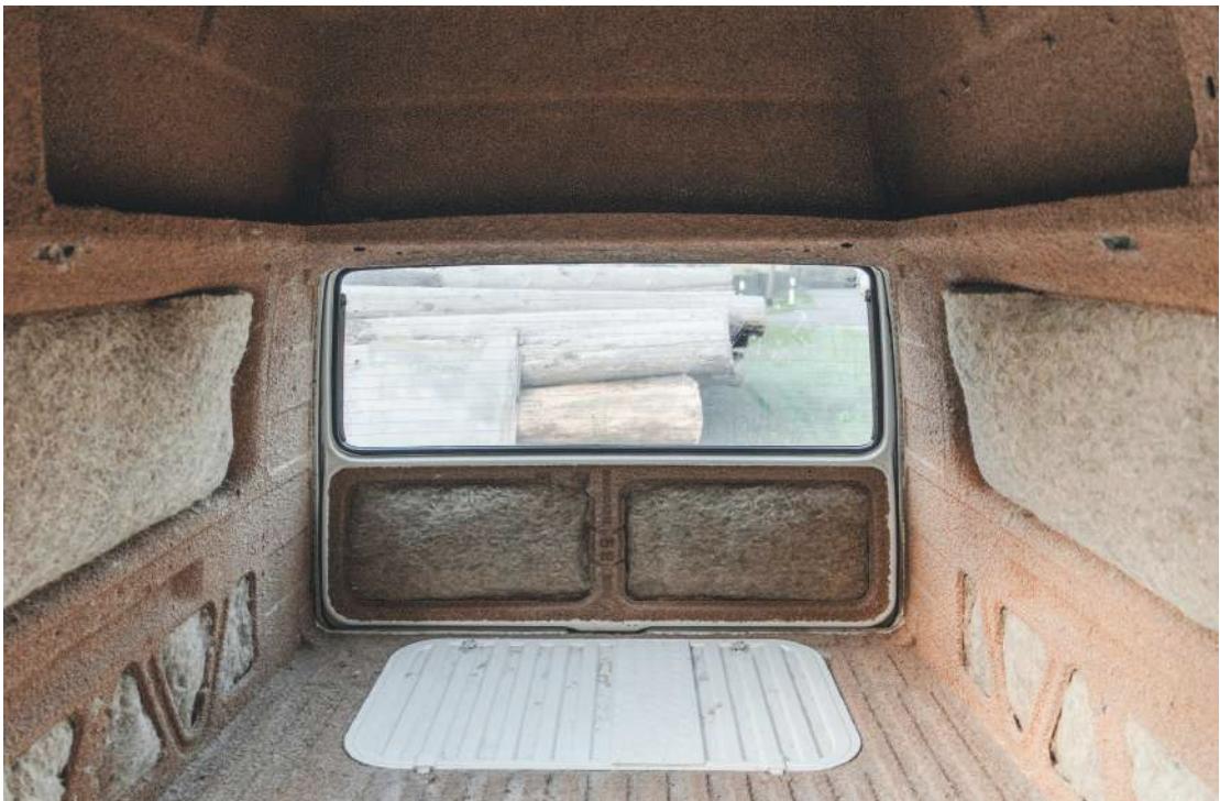
Abb.35: Kombination von Hanfdämmung und Spritzkork als wärme- und schalldämmende Schicht im VW T3.
