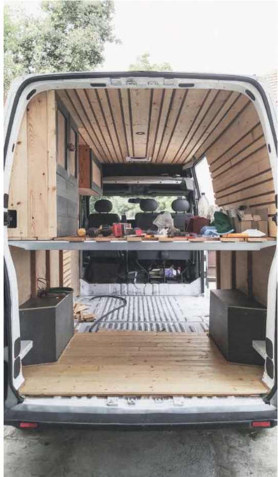
Abb.136: Mit Leinöl behandeltes Holz für Wandverkleidung und Profilholz als Bodenbelag: Natürlicher, warmer und gelblicher Farbton.
