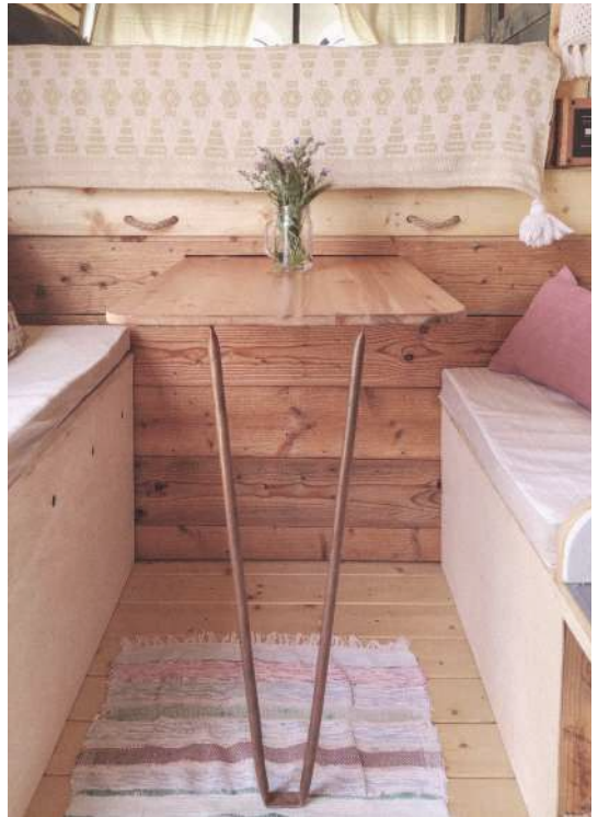
Abb.141: Altes Kupferrohr und Holzplatte vom Sperrmüll werden zu einem neuen Esstisch.
