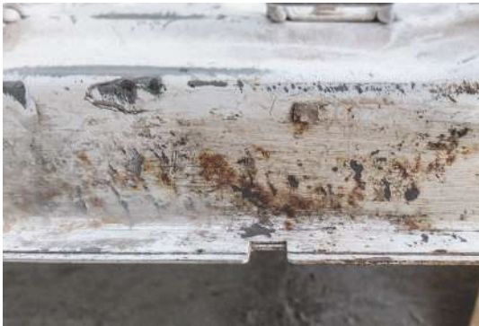
Abb.49: Rost an der Karosserie vor der Behandlung.
