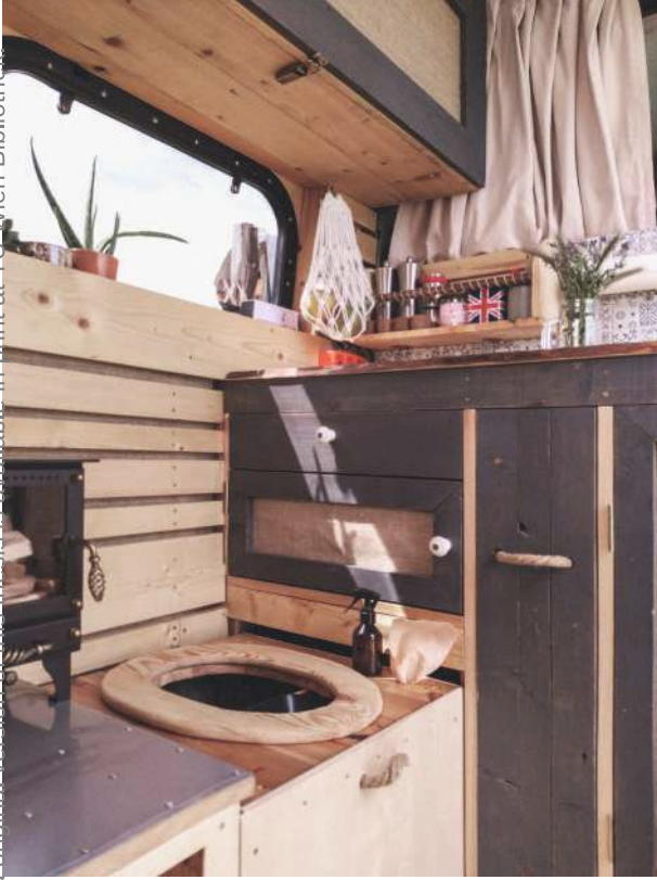
Abb.66: Eine Trockentrenntoilette versteckt unter dem Sitz.
