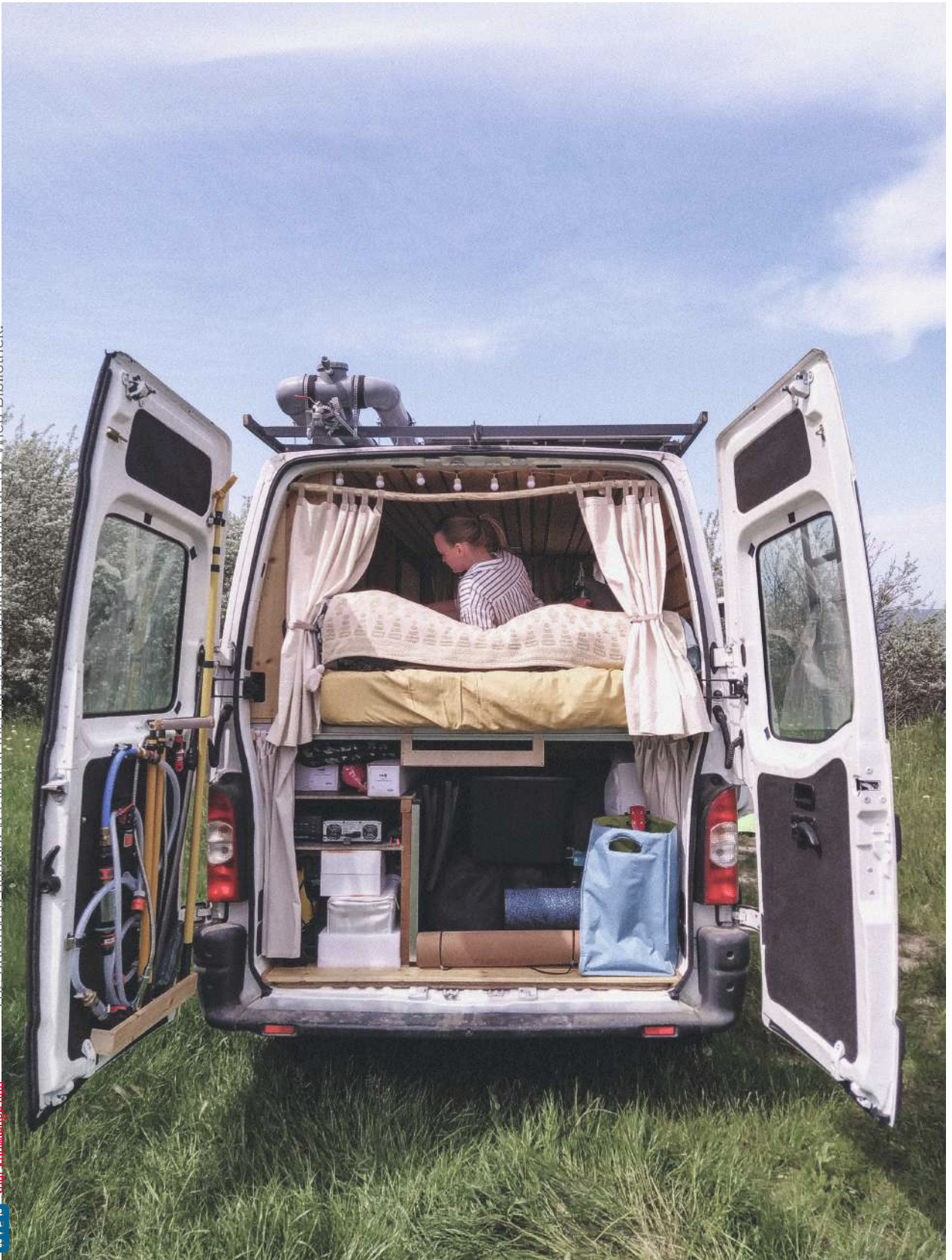
Abb.76: Garage unter dem Bett bietet ausreichend Platz für das Stromsystem und Stauraum.
