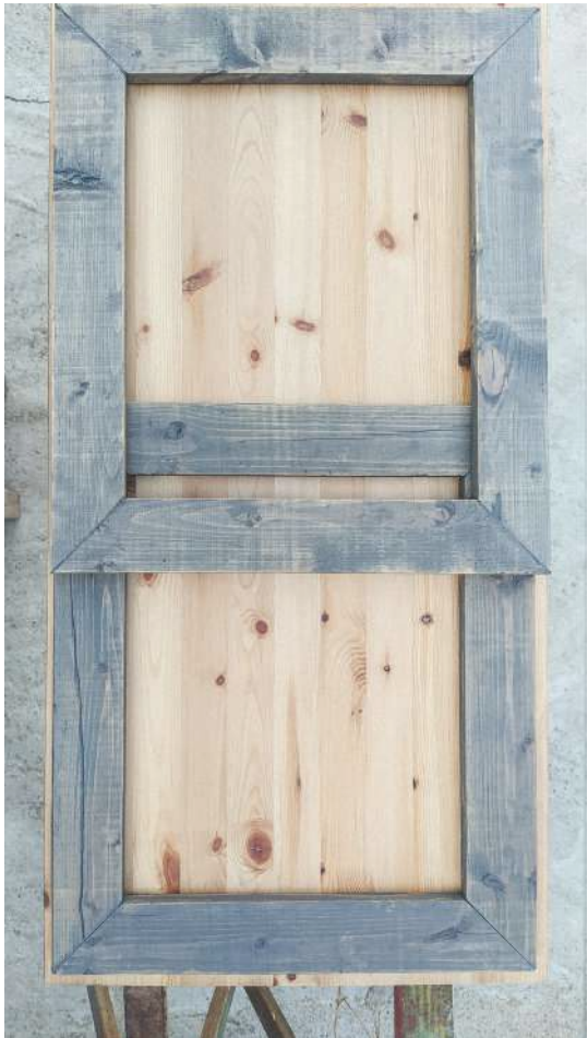
Abb.116: Holzbeize mit mineralischen Pigmenten auf Leinölfirnisbasis - Farbakzente für den Remaster.
