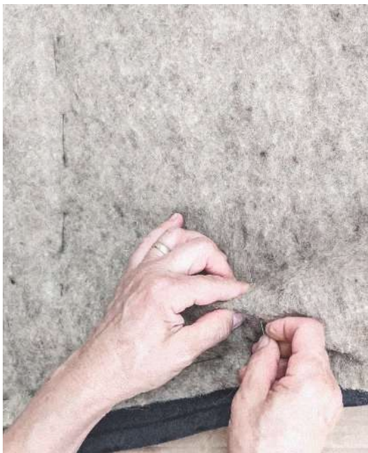
Abb.145: Anfertigen von Fensterisolierratten.
