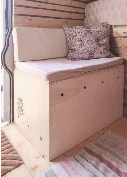
Abb.142: Lüftungsöffnungen im Sitz für eine effiziente Kühlboxbelüftung.
