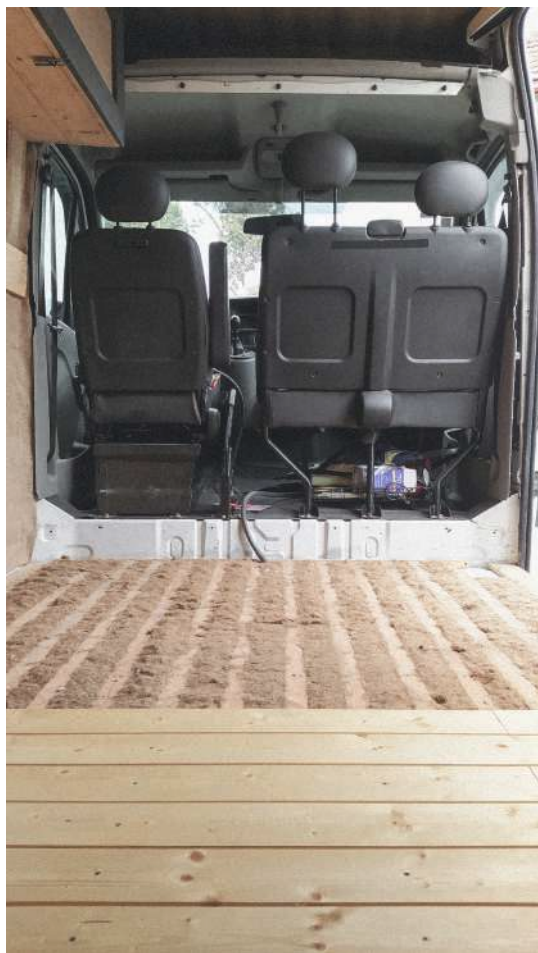
Abb.126: Verwendung von Seegrasdämmung als Fußbodendämmung.
