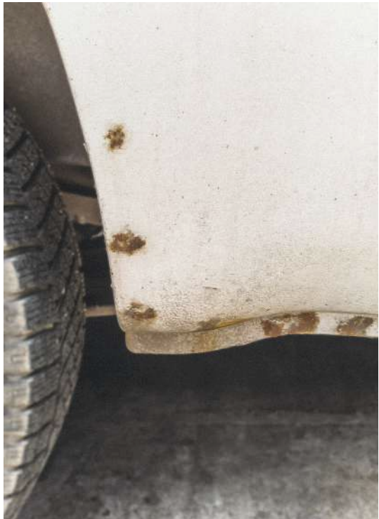
Abb.51: Feststellen von Roststellen.
