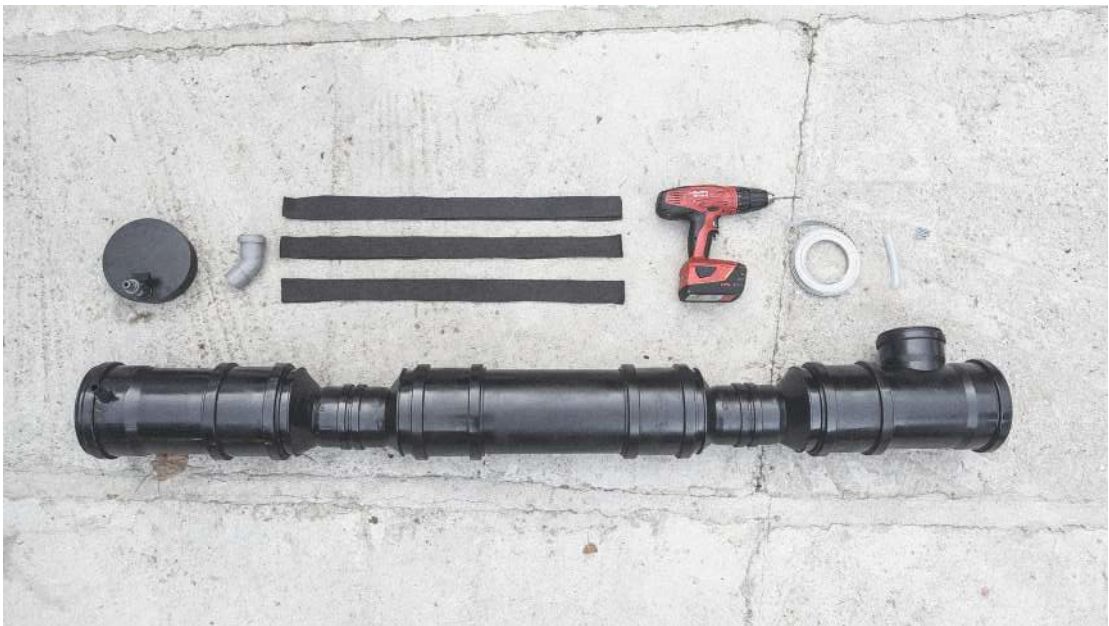
Abb.89: Abwassertank aus schwarz lackierten Abflussrohren zusammengestellt.
