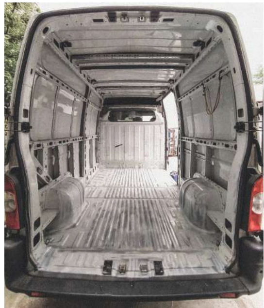
Abb.55: Grundierung und Lackierung zur Vermeidung von Rostbildungszonen.
