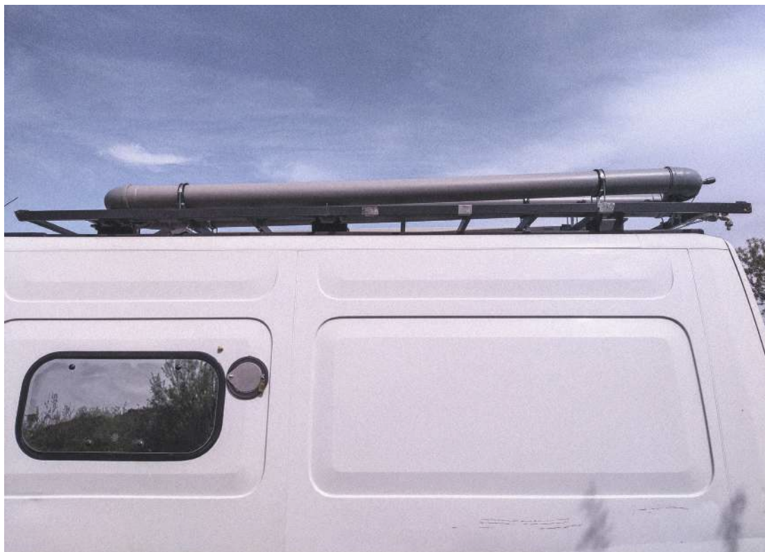
Abb.85: Sommerdusche - seitliche Ansicht.
