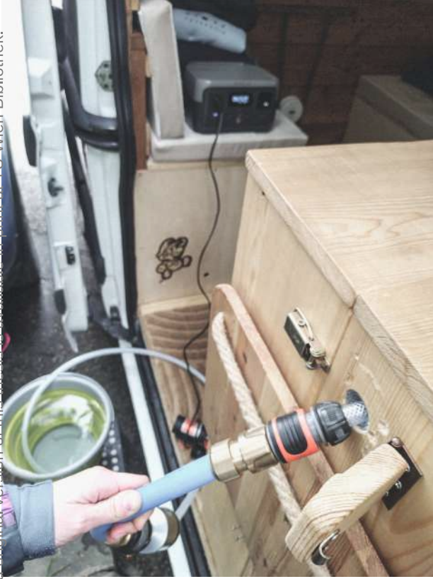
Abb.86: Befüllung des Frischwassers aus einer entfernten Quelle mit einem Eimer.
