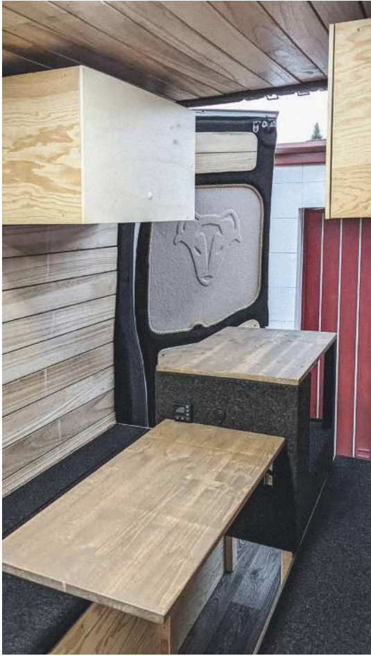
Abb.36: Filz, Leinenstoff und Pappeholz als Verkleidung für den Innenraum.
