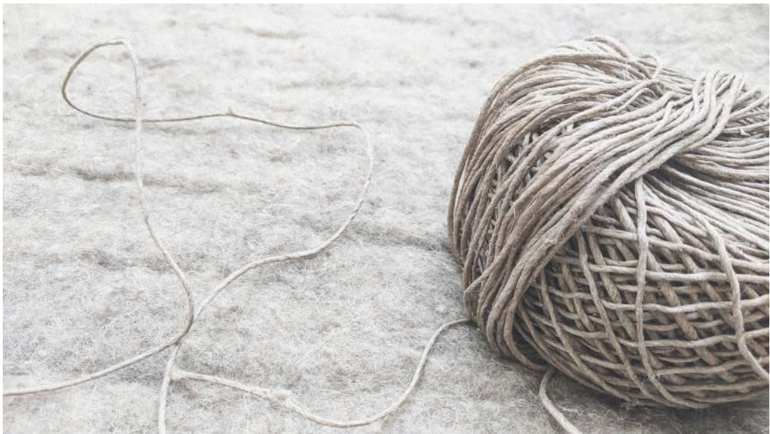
Abb.123: Kombination aus Schafwoll-Klemmfelz und Hanfkordel zur Wand- und Deckendämmung.
