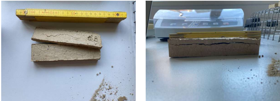
Abbildung 32: Probekörper mit 15% Wassergehalt aus nicht aktiviertem Material nach dem Trocknen
