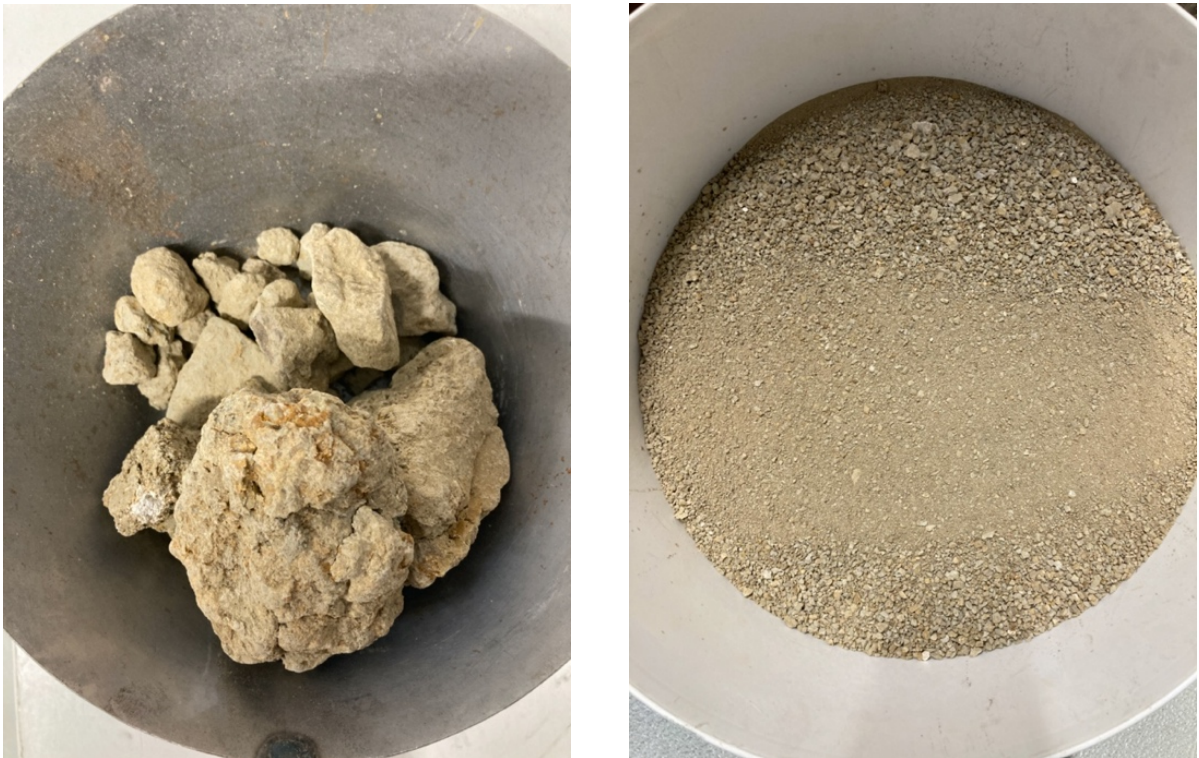
Abbildung 22: Rohmaterial vor und nach dem Brechvorgang
