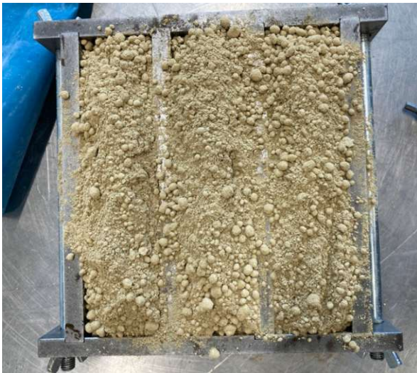
Abbildung 33: Probekörper (30 Minuten aktiviert) mit 10% Wasserzugabe vor und nach dem Verpressen mit 200 bar
