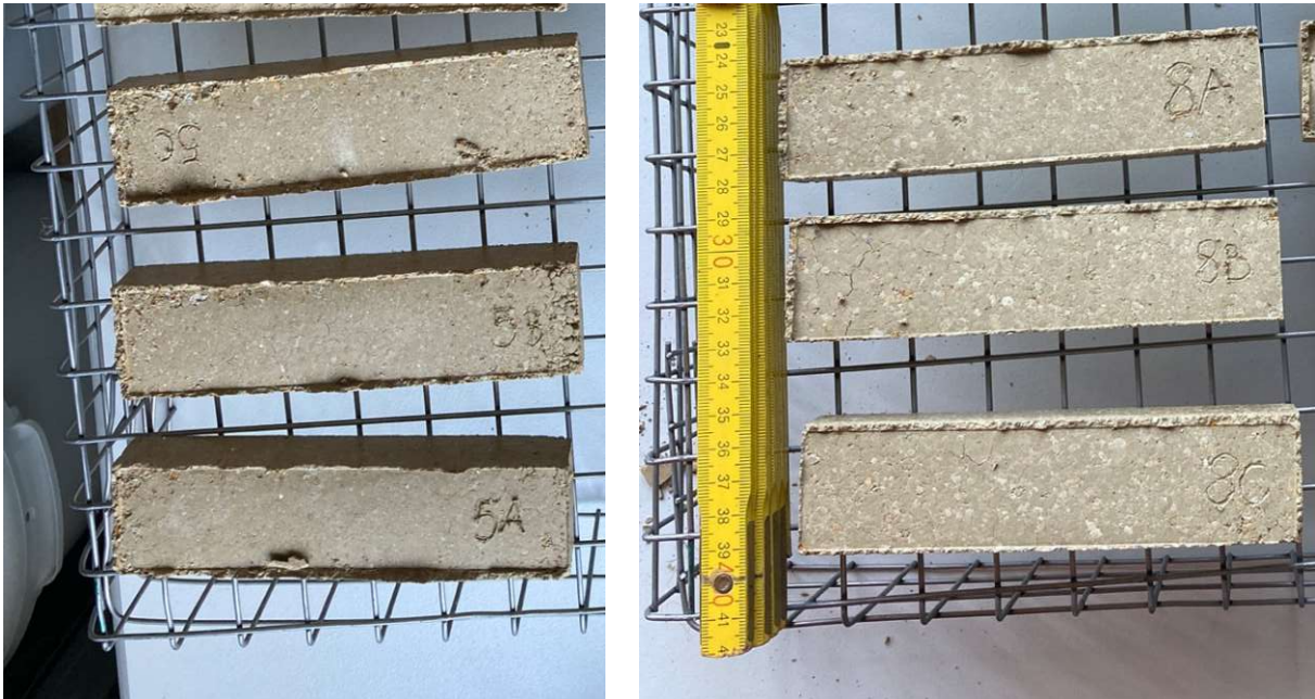
Abbildung 31: Probekörper mit 10% Wassergehalt aus nicht aktiviertem (links) bzw. aktiviertem (60 Minuten gemahlen, rechts) Material nach dem Trocknen.
