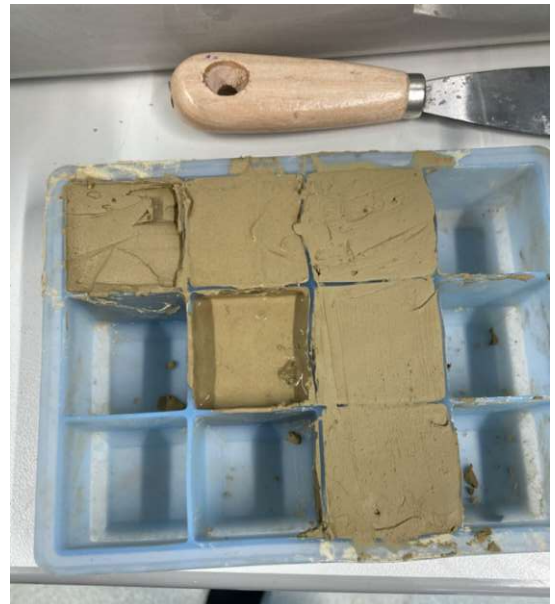
Abbildung 26: Herstellung von würfelförmigen Probekörpern mit Silikonformen
