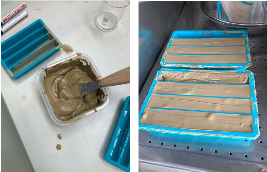
Abbildung 25: Herstellung von prismenförmigen Probekörpern mit Silikonformen
