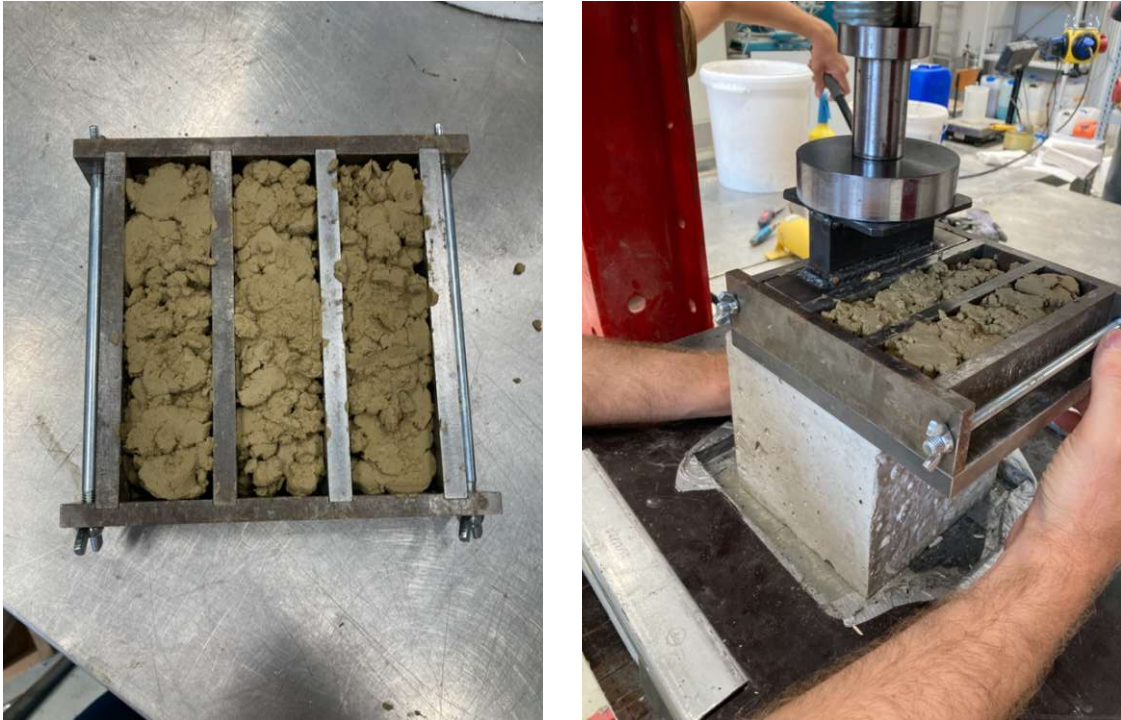
Abbildung 27: Herstellung von prismenförmigen Probekörpern in Stahlformen
