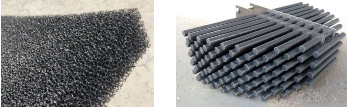
Abbildung 19: Filtermaterial ppi10 (links) und zylinderförmiger Verkläunungskörper aus Kunststoffstäben (rechts)
