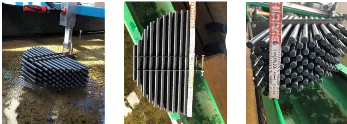
Abbildung 18: Zylinderförmiger Verkläuerkörper aus Kunststoffstäben
