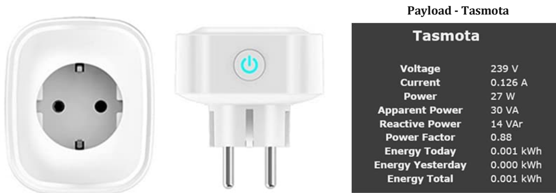
Abbildung 20: Smart Plug (Gosund, 2023) und Software Tasmota
