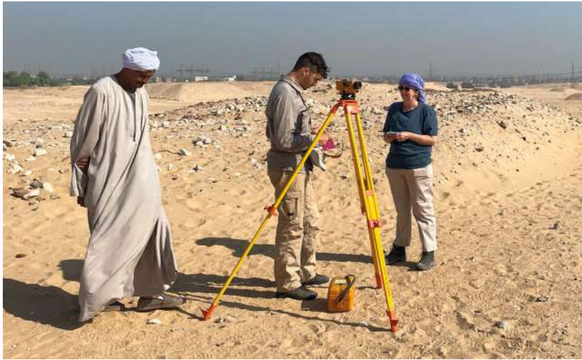
Abb.67: Einmessen der Höhenlage der Mauerkronen
