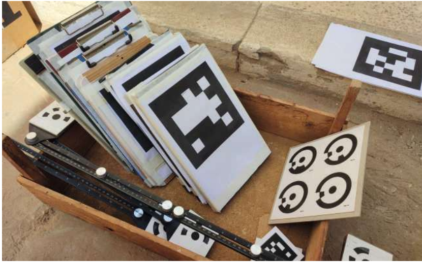
Abb.77: Unterschiedliche Marker für die spätere Modellberechnung
