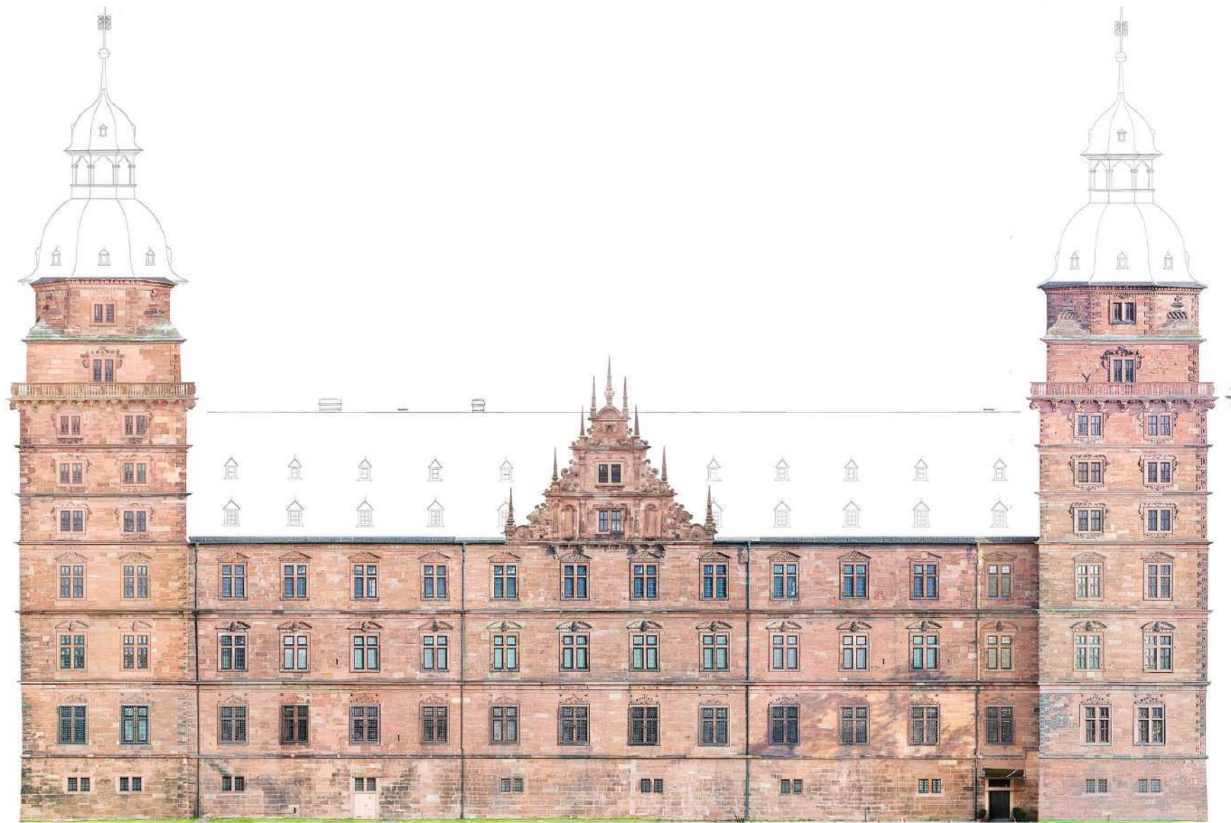
Abb.14: Fotogrammetrische Aufnahme der Fassaden, Schloss Johannisburg in Aschaffenburg, Deutschland
