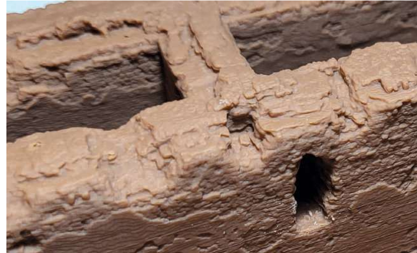
Abb.111: Testdruck SLA Detail der Mauerkrone im Maßstab 1:100
