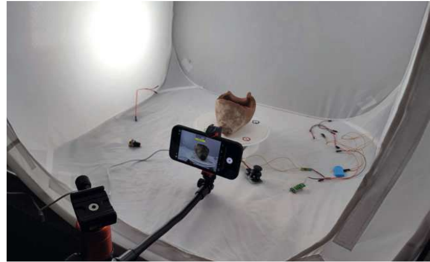
Abb.6: Fotobox mit Kunstlicht zur fotogrammetrischen Aufnahme
