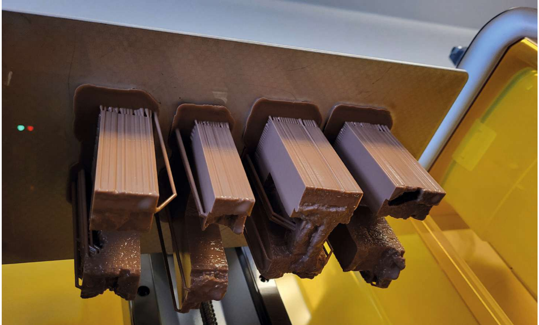
Abb.125: Testdruck im Maßstab 1:50, geteiltes Modell für Schnittflächentest
