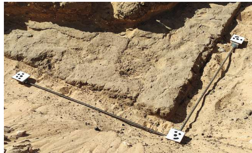
Abb.10: Coded target auf einer Stange mit fixem Abstand, Abydos
