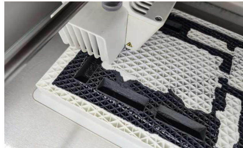
Abb.117: Testdruck mit 30% Infill zur Materialreduktion
