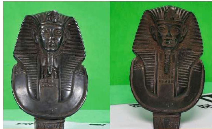
Abb.7: Reduzierung der Spiegelung durch Polarisationsfilter
