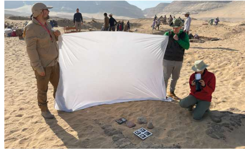
Abb.74: Testaufnahmen mit Beschattungstuch, ColorChecker und Marker
