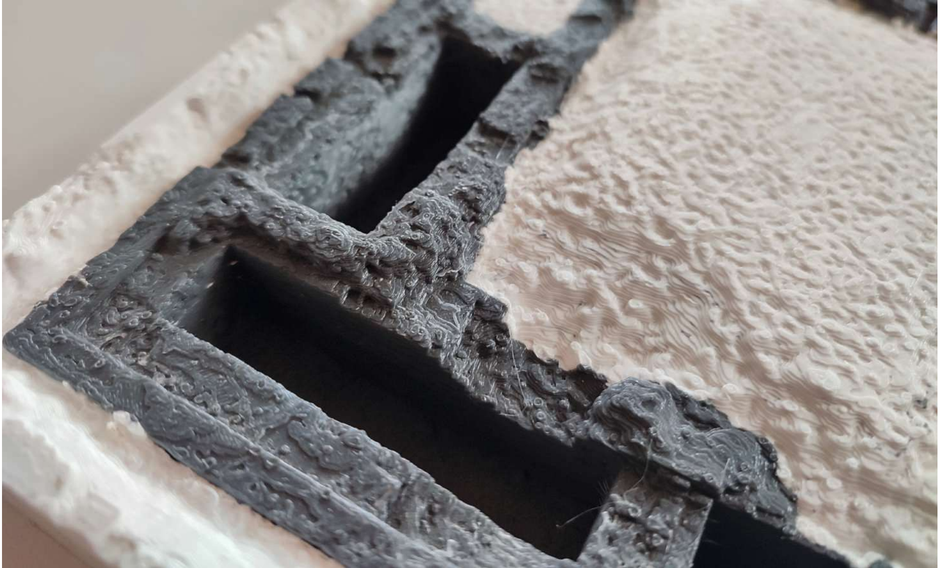
Abb.118: Testdruck mit den Ultimaker S5 Dual Extruder FDM, YKK-5 und YKK-6 nach der ersten Kampagne
