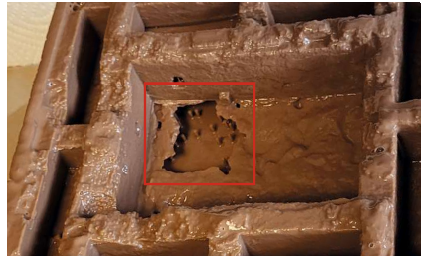
Abb.132: Fehlende Teile im Druck aufgrund einer zu geringen Stützstruktur
