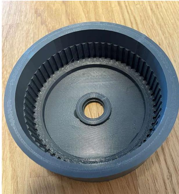
Abbildung 6.1.: Vereinfachtes 3D gedrucktes Gehäuse mit Nuten für Pins
