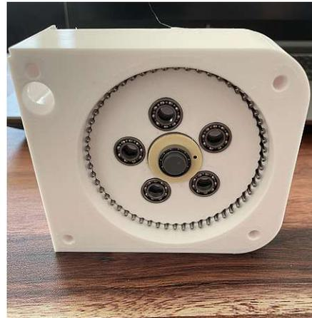
(d) Zusammengebaute Kugellagervariante
