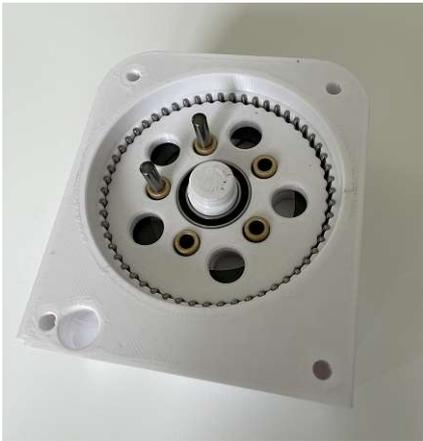
(c) Zusammengebaute Gleitlagervariante
