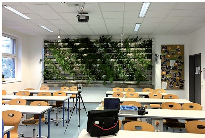
Schimmelsporenmessung in einem begrüntem Wiener Klassenzimmer mit Aluminiumtrogsystem.
