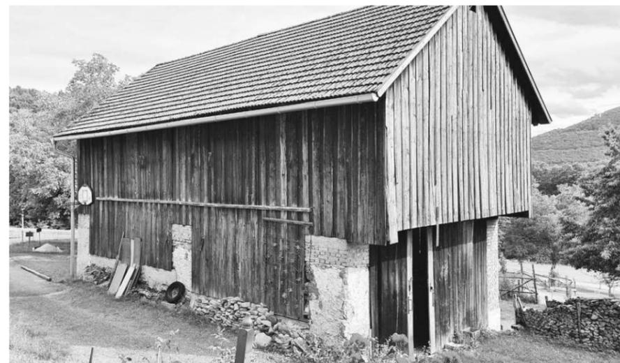
Abb. 57: Stadel in Mischbauweise, Ständerbau mit gemauerten Pfeilern und Satteldach.
