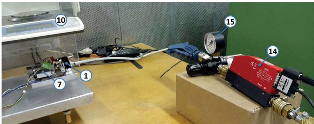
Abbildung 4.4: Offener, pneumatischer Kreislauf für die Messungen mit Druckluft: die Turbine (1), der Generator (7), die Laborwaage (10), Massenstromregler (14) und Manometer (15).
