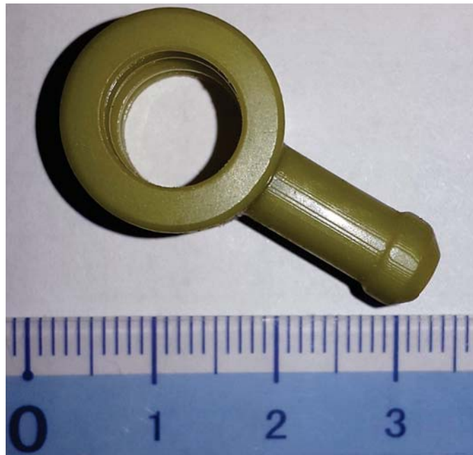
Abbildung 3.16: Saugseitiger Schlauchanschluss nach Entfernung der Stützstruktur.
