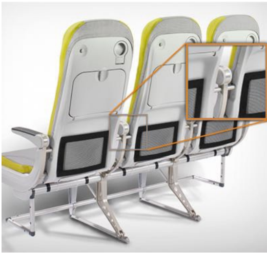
Abbildung 58: klein dimensionierte Rückenlehnenlagerung von Recaro 11
