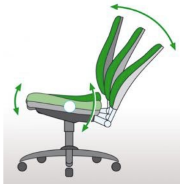
Abbildung 71: Drehpunkt der Rückenlehne bei einem Bürosessel 24
