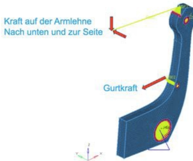
Abbildung 103: Modell des Armlehnenträgers für die Topologieoptimierung
