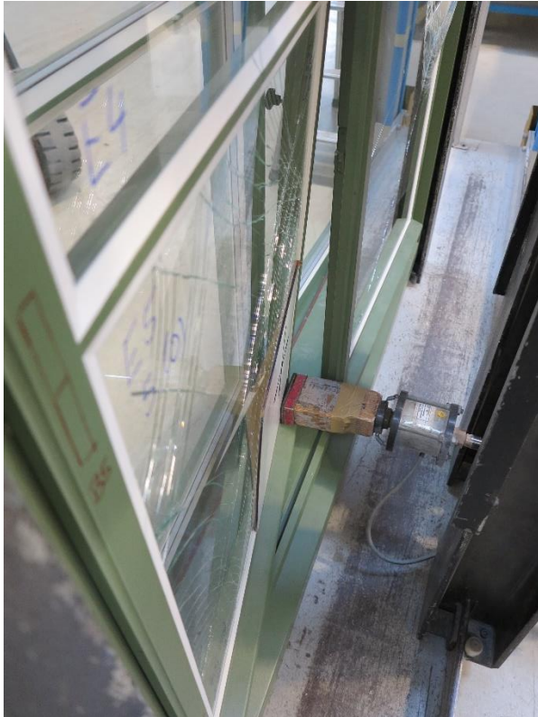
Abbildung 65: Links: statische Belastung des Gehflügels im unteren Stulpbereich (Belastungspunkt Gfl V4), der äußere Flügel verformt sich so stark, dass er bereits auf den inneren Flügel drückt; Rechts: Verformung des inneren Treibriegels!
