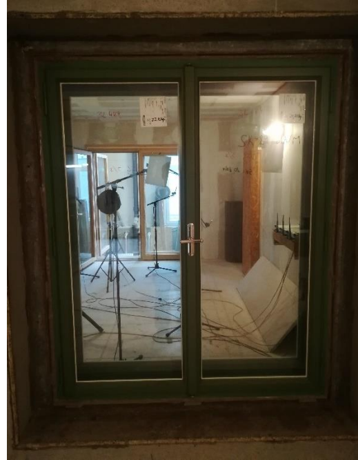
Abbildung 22: Einbausituation des Kastenfensters bei SA 121 mm und SA 171 mm, links senderraumseitig und rechts empfangsraumseitig
