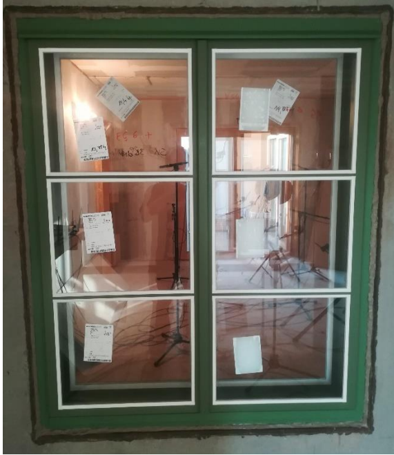
Abbildung 22: Einbausituation des Kastenfensters bei SA 121 mm und SA 171 mm, links senderraumseitig und rechts empfangsraumseitig
