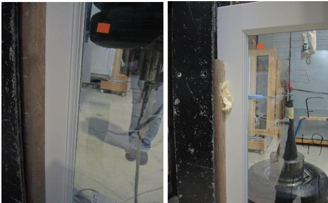
Abbildung 57: Vakuum-Verglasung mit 1x VSG 3/4v4: Rissbildung im Glas bei Auftreffpunkt c; Ansicht von Innenseite
