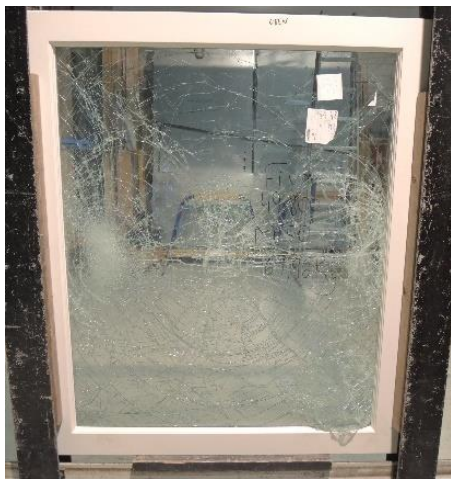
Abbildung 60: Vakuum-Verglasung mit 2x VSG 3/4v4/3: Ansicht von der Innenseite nach dem Versuch
