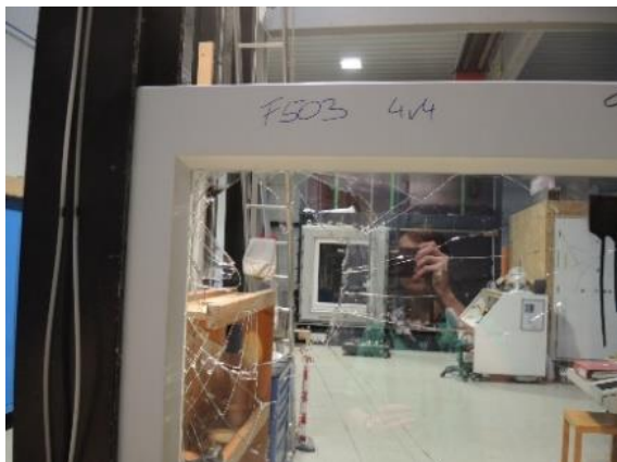
Abbildung 54: Vakuum-Verglasung 4v4: Glasbruch am Auftreffpunkt a und größtes losgelöstes Glas-Bruchstück
