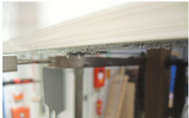
Abbildung 77: Beispiel für Kondensat: Klasse 2 (Tropfen sichtbar, jedoch nicht ab rinnend); teilflächig (T)
