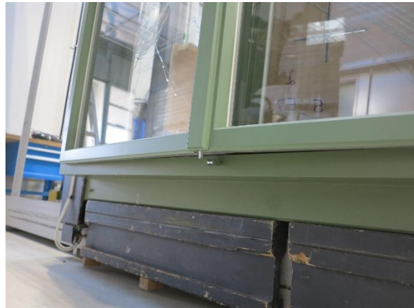
Abbildung 65: Links: statische Belastung des Gehflügels im unteren Stulpbereich (Belastungspunkt Gfl V4), der äußere Flügel verformt sich so stark, dass er bereits auf den inneren Flügel drückt; Rechts: Verformung des inneren Treibriegels!
