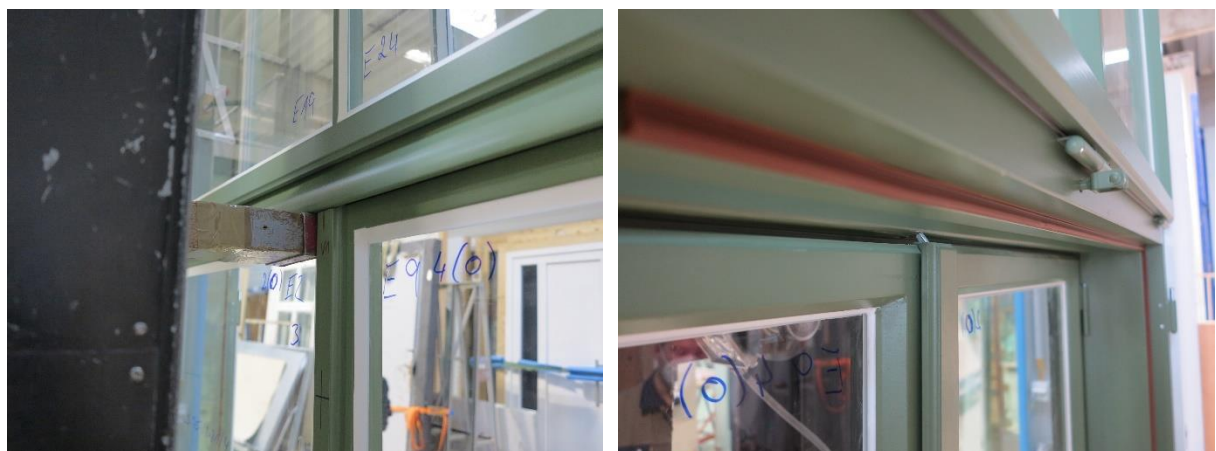
Abbildung 64: Links: statische Belastung des Gehflügels im oberen Stulpbereich (Belastungspunkt Gfl V1); Rechts: Verformung des äußeren Treibriegels
