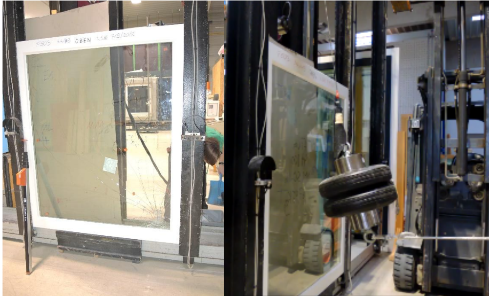
Abbildung 52: Links, Ansicht einer der Fixverglasungen von außen, eingebaut im Prüfstand der Holzforschung Austria; Rechts, Pendel mit Zwillingsreifen (Stoßkörper)
