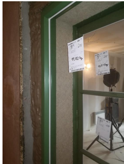
Abbildung 23: Empfangsraumseitige Einbausituation des Kastenfensters bei SA 271 mm
