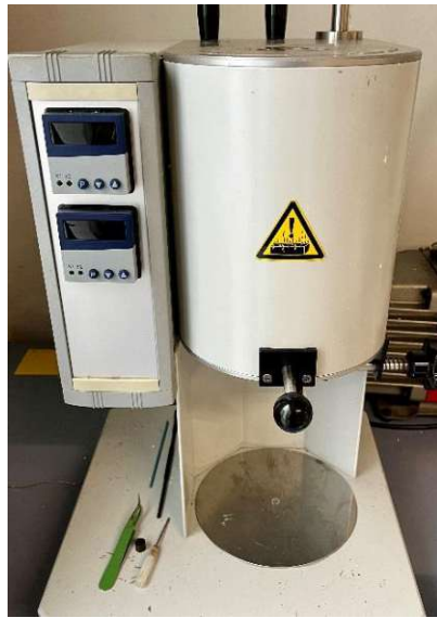
Abbildung 18: Messgerät von MFR Melt Flow Basic 3100.000 (li.) und die Auflagemasse von 5 kg (re.)
