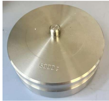
Abbildung 18: Messgerät von MFR Melt Flow Basic 3100.000 (li.) und die Auflagemasse von 5 kg (re.)
