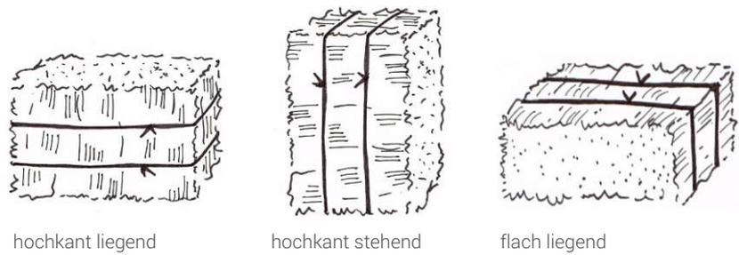
Abb 10 Halmausrichtung im Strohballe (Darstellung: FASBA-SBR 2019: 15)
