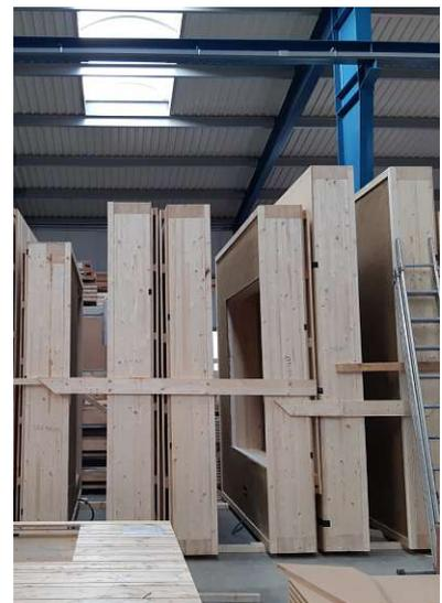
Abb 55 vivihouse-Wandmodule in Vorfertigung
