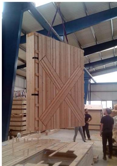
Abb 54 vivihouse-Wandmodul, außen, Holzfaser-Unterdeckplatten und hinterlüftete Holzfassade
