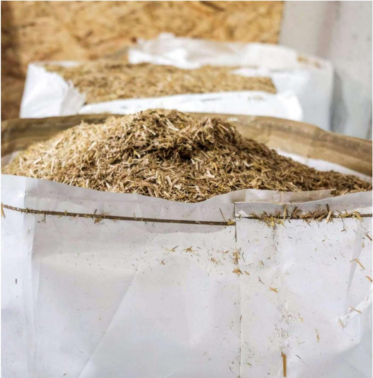
Abb 18 Strohhäcksel dämmung (Foto: DPM Holzdesign / dpm-gruppe.com)
