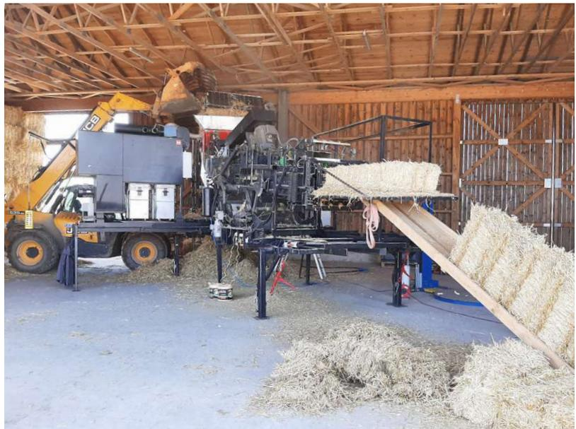
Abb 13 Pressung geeigneter Baustrohballen beim Kunden mit mobiler Aufbereitungsanlage (Foto: SonnenKlee / sonnenklee.at)
