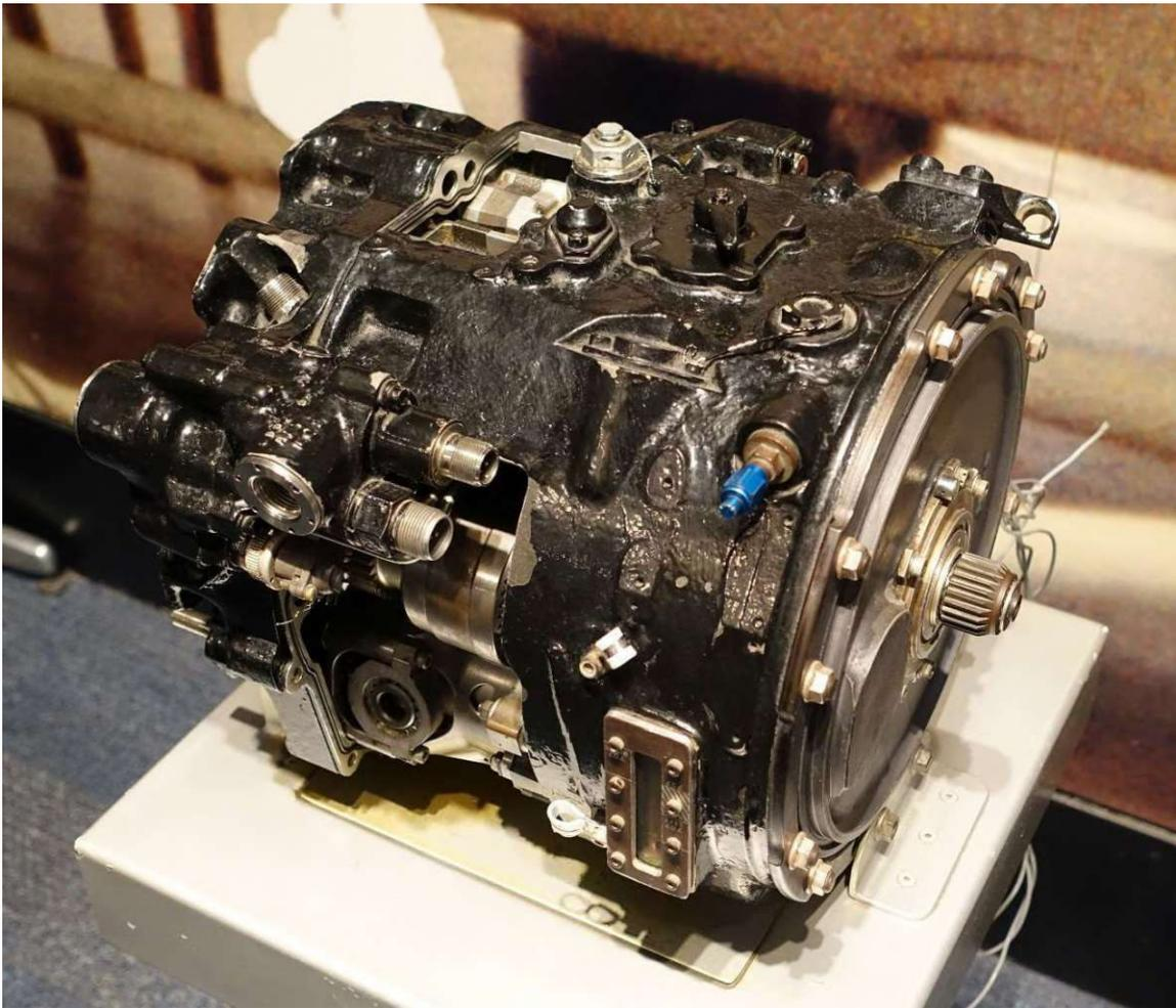
*Abbildung 46: Constant Speed Drive (CSD) für eine Boeing 727, hergestellt von der Firma „Sundstrand Corporation“*
