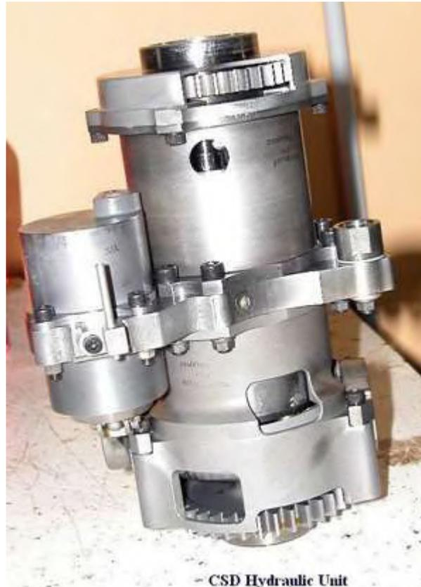
*Abbildung 49: Hydraulikeinheit mit Steuerzylinder der variablen Taumelscheibe [58]*
