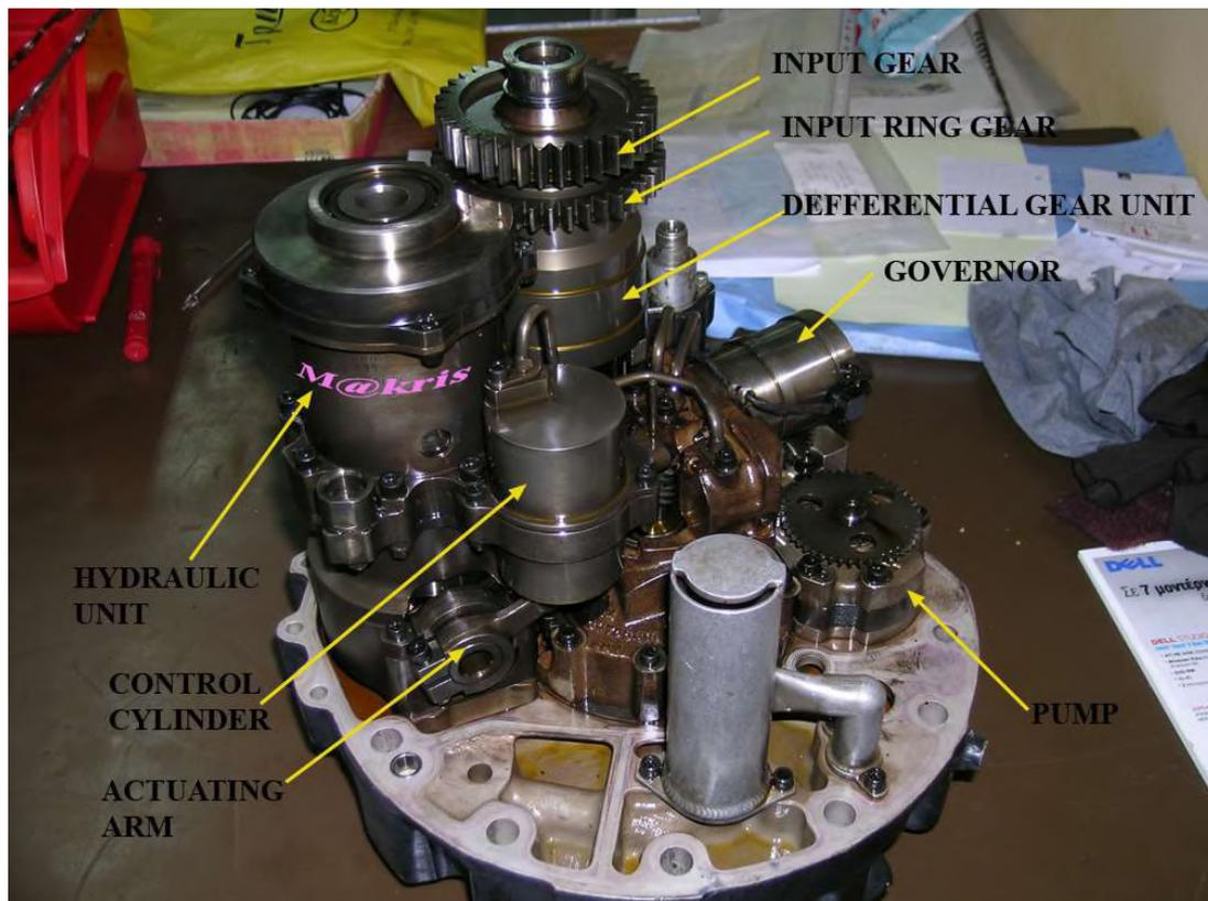
Abbildung 48: Breispiel eines realen Aufbaus eines CSDs [58]
