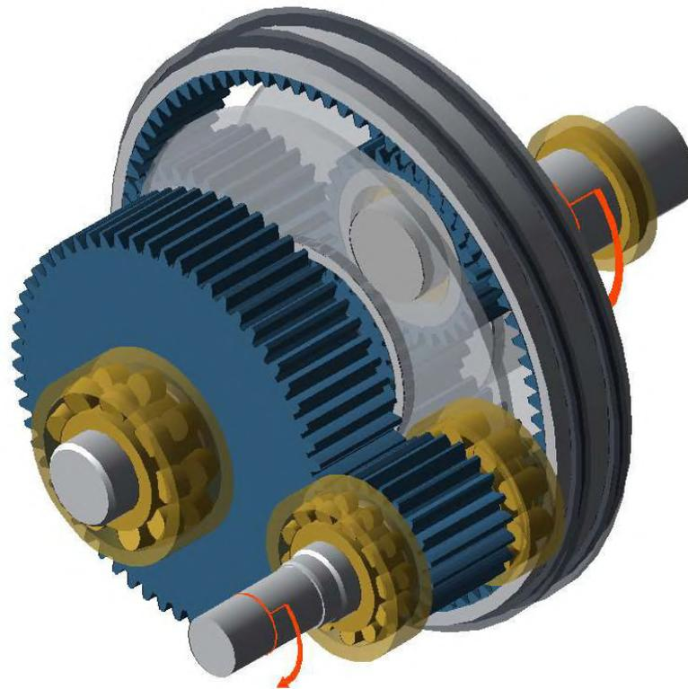
Abbildung 60: 3D-Modell - Getriebezug V6 aufgebaut in der FVA-Workbench
