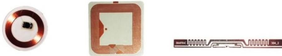
Abb. 036: Antennen / Spulen, S. 399
