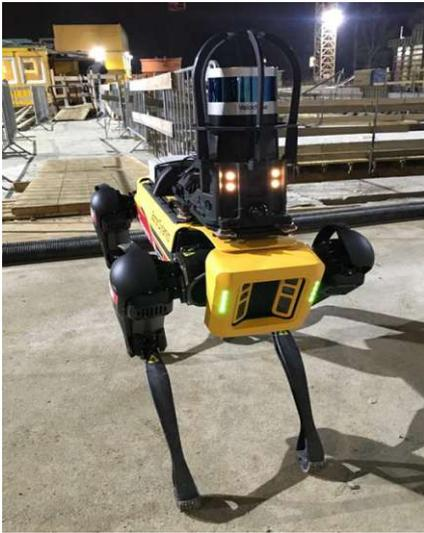
Abb. 285 - 286: Robohund „Spot“ mit LiDAR Aufsatz bei Fotodokumentation, S. 410
