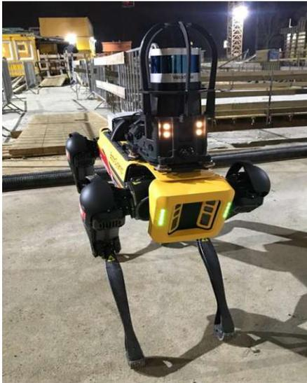
Abb. 285 - 286: Robohund „Spot“ mit LiDAR Aufsatz bei Fotodokumentation, S. 410
