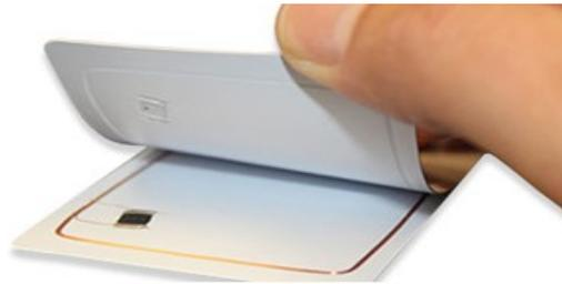
Abb. 055: Smartlabel - Aufbau, S. 400
