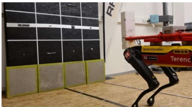
Abb. 281: Test mit linearpolarisierter Antenne Typ2, S. 410
