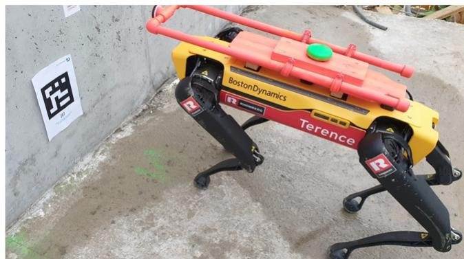
Abb. 275: Robohund „Spot“ im Autowalk-Modus, S. 409
