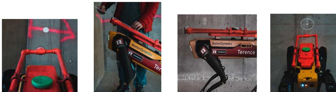
Abb. 292 - 295: Robohund „Spot“ mit Aufsatz für RFID-Support auf Baustelle, S. 410
