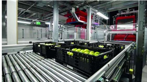
Abb. 089: Mehrwegbehälter RFID-Tracking, S. 402
