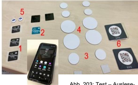
Abb. 203: Test – Auslese-Reichweiten HF (NFC) Labor, S. 407
