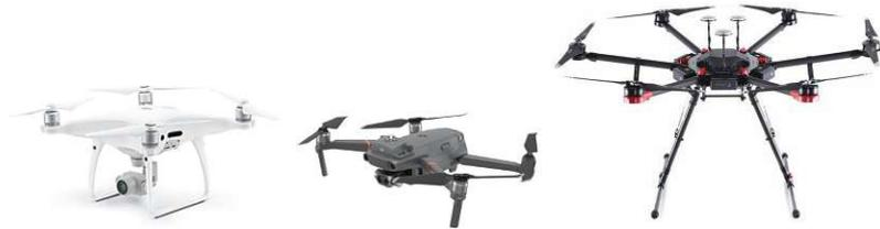
Im Sinne von Outdoorflügen kam die DJI Matrice 600 Pro mit entsprechender Zusatzausrüstung (redundantes System – GNSS, Fernbedienung, Akku, Fallschirm) zum Einsatz, die alle Bedingungen für einen Gebrauch im dicht besiedelten Gebiet erfüllt.
