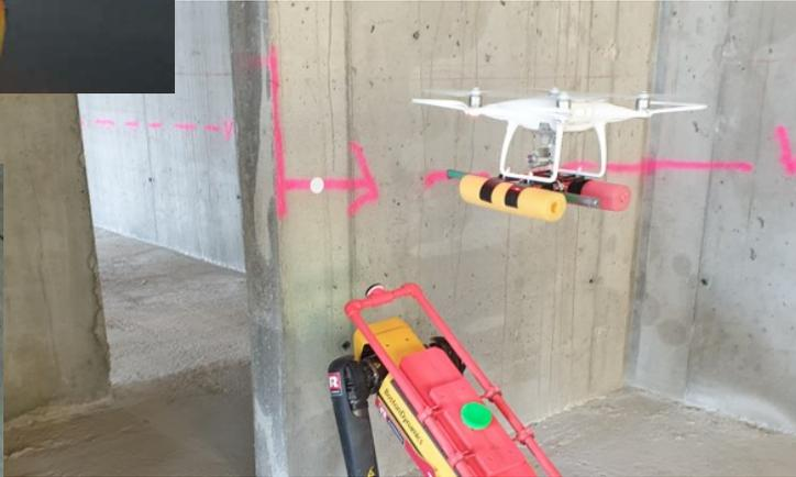
Abb. 318 - 321: Drohnen mit Aufsatz für RFID-Support auf Baustelle, S. 411
