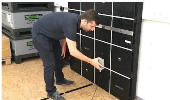
Abb. 199: Test mit zirkularpolarisierter Antenne, S. 407
