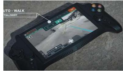
Abb. 276: Robohund „Spot“ Controller, S. 409
