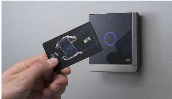
Abb. 115: RFID-Zutrittskontrolle Terminal, S. 404
