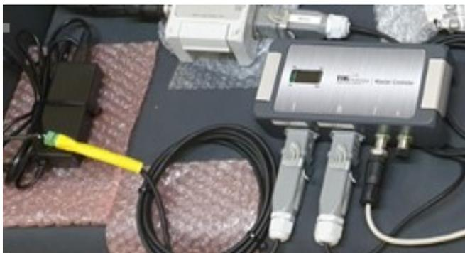
Abb. 190: UHF Controller (Mastercontroller), S. 406
