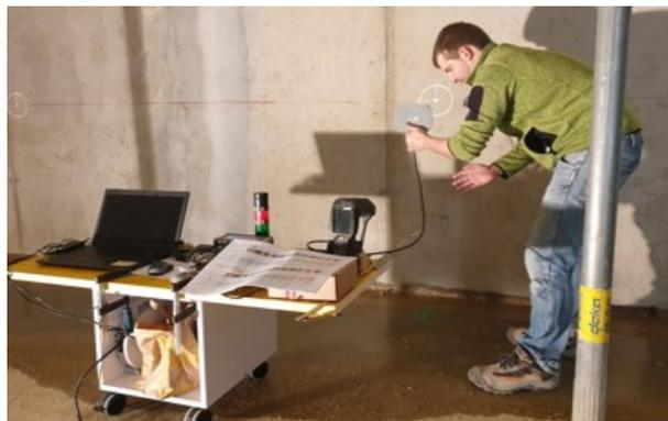
Abb. 205: Test – Auslesereichweiten UHF Reader auf Baustelle, S. 407
