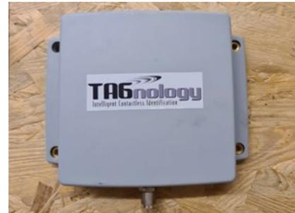
Abb. 187: Zirkularpolarisierte UHF Antenne, S. 406
