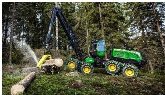
Abb. 095: hochmechanisierte Holzfällung, S. 403
