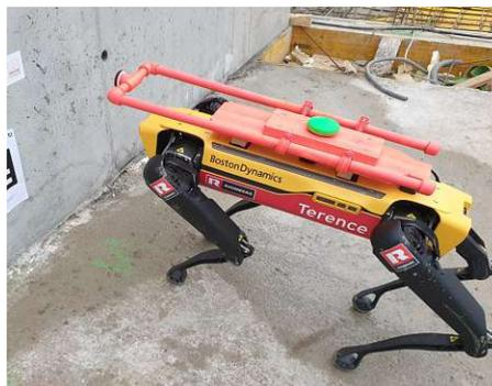
Abb. 278 - 279: Robohund „Spot“ Aufsatz fertig für RFID-Support, S. 409
