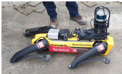
Abb. 284: Robohund „Spot“ mit LiDAR und Core Aufsatz, S. 410
