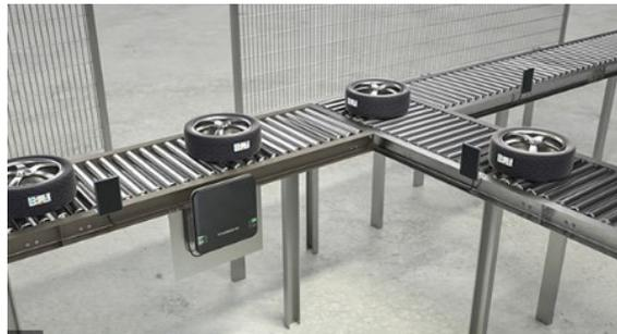
Abb. 065: Stationärer Reader am Lauf-Rollenband, S. 401
