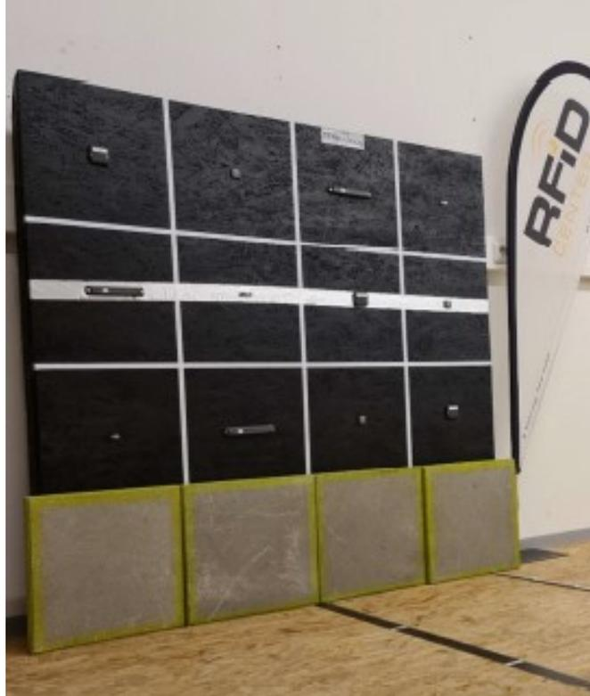
Abb. 194a: Matrix-förmige Testwand UHF Labor, S. 406
