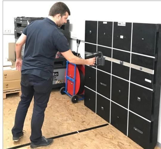
Abb. 202: Test – Auslesereichweiten UHF Handheld Labor, S. 407
