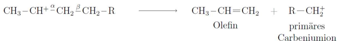
Abbildung 11: Bildung von ein Olefin und ein primäres Carbeniumion [18]
