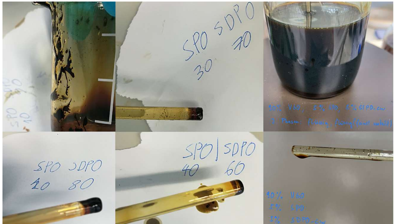
Abbildung 46: Bestimmung der Mischungsgrad von SPO und SDPO im VGO
