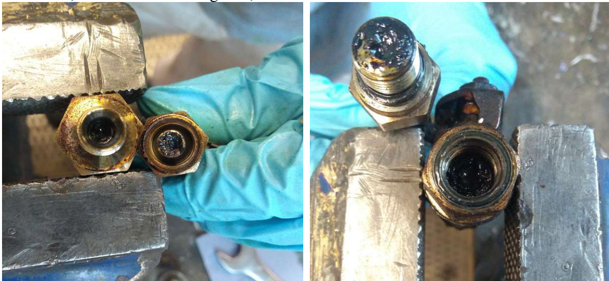
a b Abbildung 56: Feststoffbildung in den Leitungen bei der 5% SDPO-Beimischung mit zusätzlichem Feedstrang
