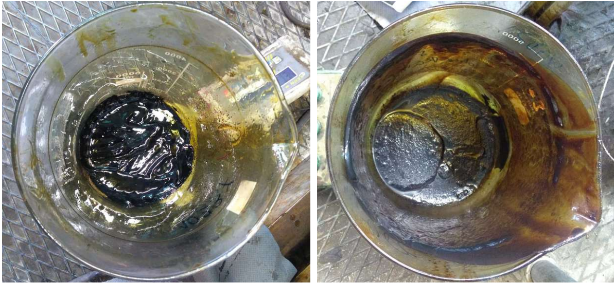
c d Abbildung 55: Feststoffbildung bei der 10% SDPO-Beimischung
