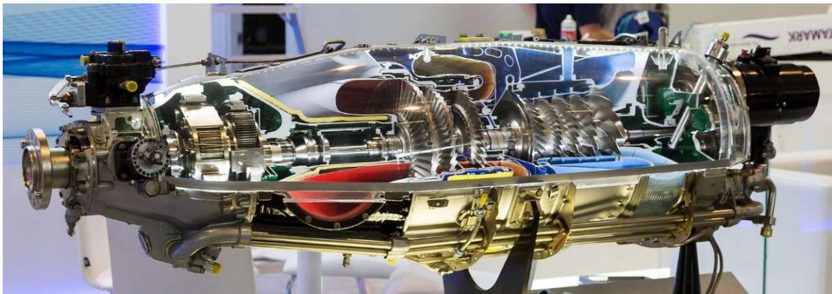
Abbildung 5: Aufbau einer PT6A-68B. [34]
