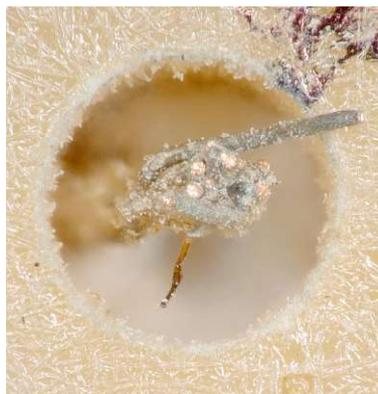
Abbildung 5.5: Versagen durch Riss im Draht nach Vibrationsprüfung in einer Achse
