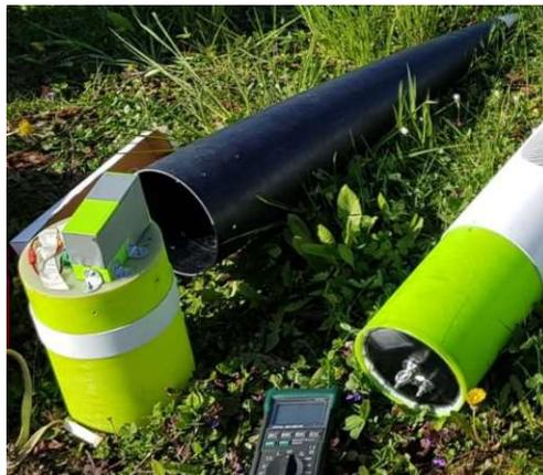
Abbildung 5.12: Positionierung des Sensorpaketes in der Raketenspitze beim Testflug
