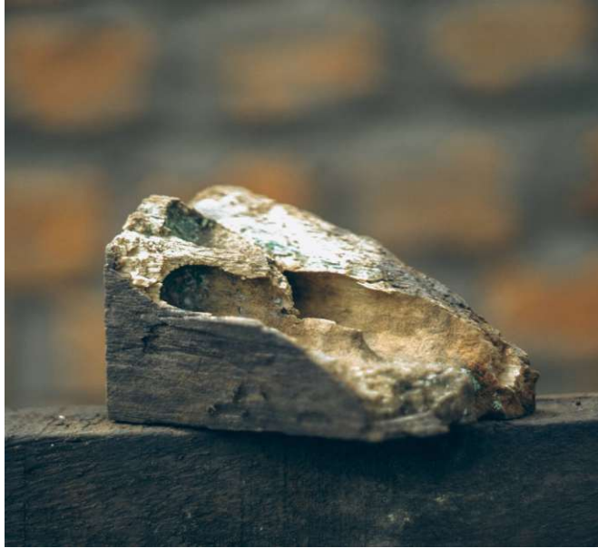
Abb. 86: Von Flying Beetles befallenes Holzstück seitlich
