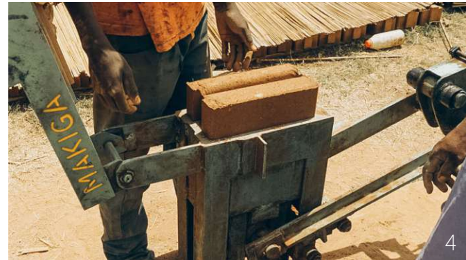
Abb. 118: Ziegel ist fertig gepresst
