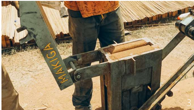
Abb. 117: Hebel wird wieder hochgehoben
