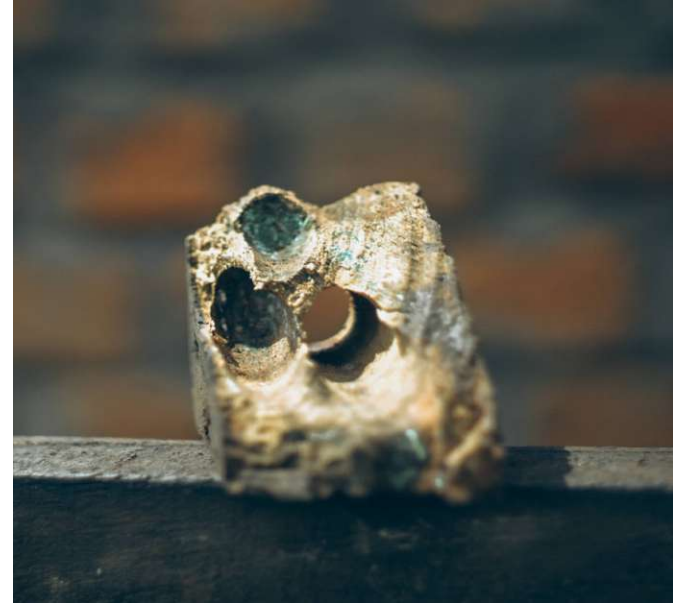
Abb. 87: Von Flying Beetles befallenes Holzstück frontal
