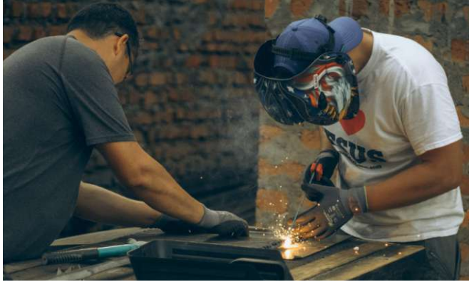
Abb. 92: Termitenbleche werden geschweißt
