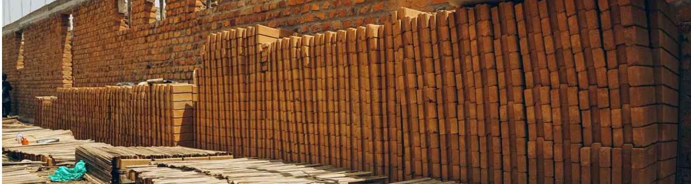
Abb. 108: Gepresste Luftgetrocknete Ziegel
