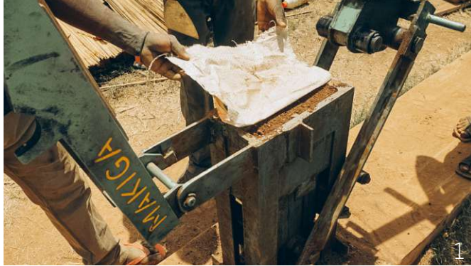
Abb. 115: Murram-Sand-Zement-Gemisch wird in die Presse gefüllt
