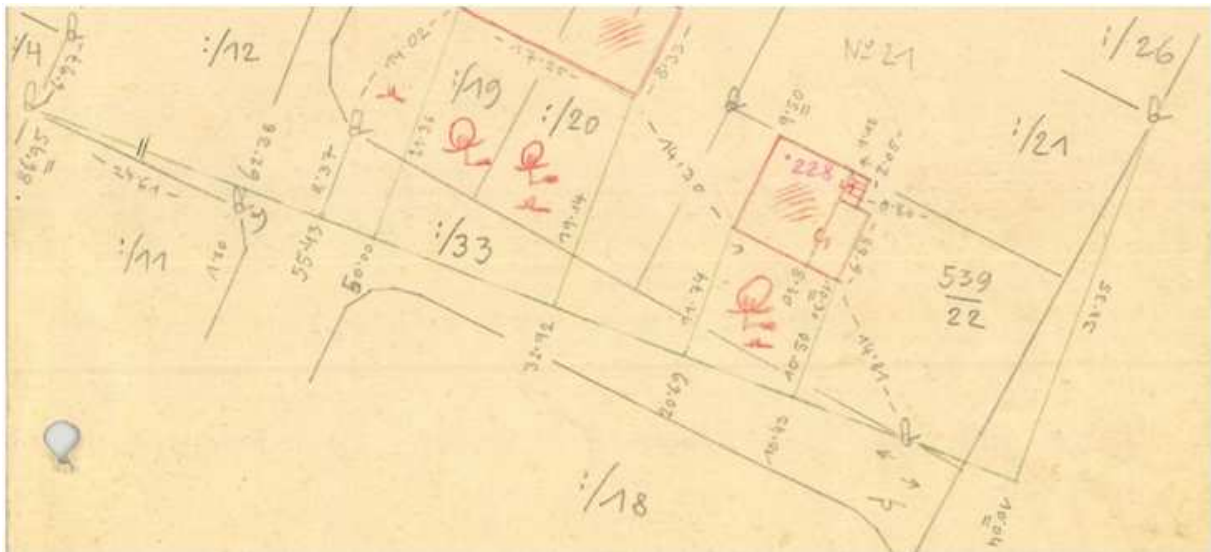
Abbildung 14: Ausschnitt eines Planes mit Orthogonalmethode [BEV]
