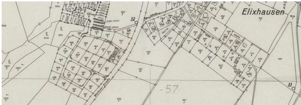
Abbildung 7: Ausschnitt von einer Mutterpause auf Astralon [BEV]
