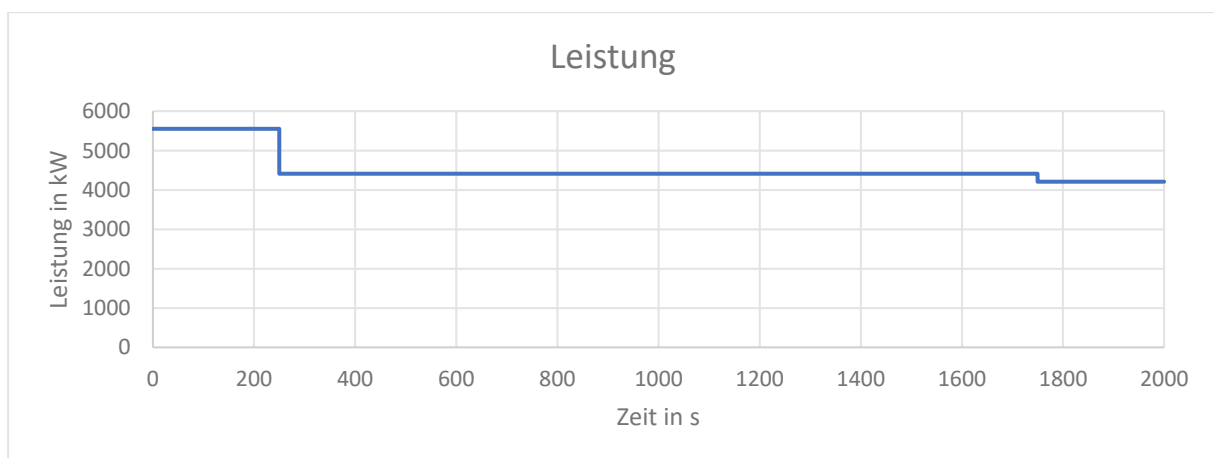
Abbildung 7.7: Zeitlicher Verlauf der Leistung im Referenzszenario [29].
