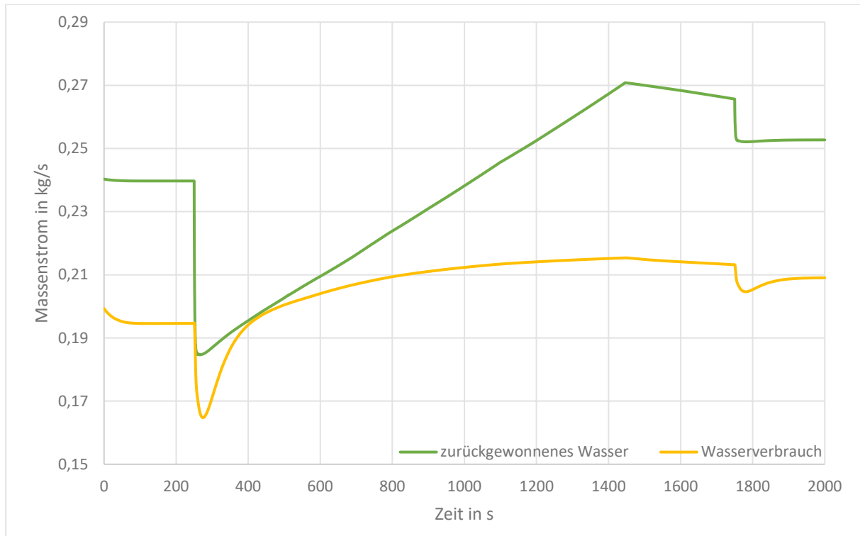
Abbildung 7.13: Wasserbilanz des Systems (2,675 bar Betriebsdruck; Referenzszenario).
