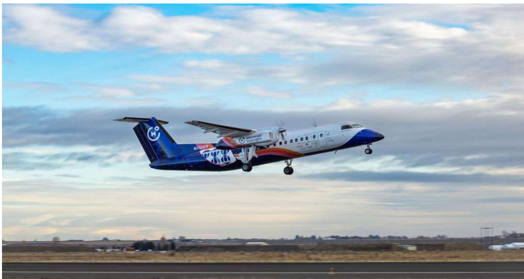
Abbildung 4.1: Modifizierte Dash 8Q-300 mit einem durch Brennstoffzellen betriebenen Triebwerk [26].
