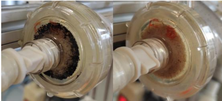
Abbildung 10 Feed-Seite des VO-Moduls nach dem Versuch Nr. 38 (links) und Nr. 39 (rechts) (NaCl+1mg/L NH 4 -N Ⓢ A; vgl. Tabelle 13) beim linken wurde kein Ultraschallbad zum Lösen verwendet.
