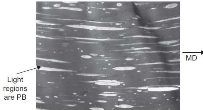
Abbildung 3.6 – Streckung der Zweitphase (Polybuten PB) durch den Folienblasprozess in einer Polyolefin-Matrix (MD: machine direction, entspricht der longitudinalen Richtung) [48]
