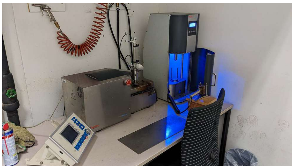
Abbildung 3.2 – Haake Mini Lab (links) und Haake Mini Jet II (rechts)
