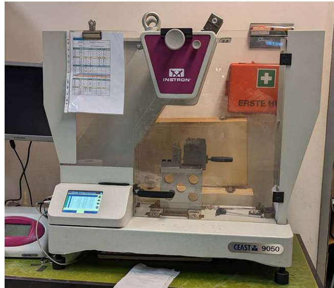
Abbildung 3.13 – Schlagzugversuch: Pendelschlagwerk Instron Ceast 9050
