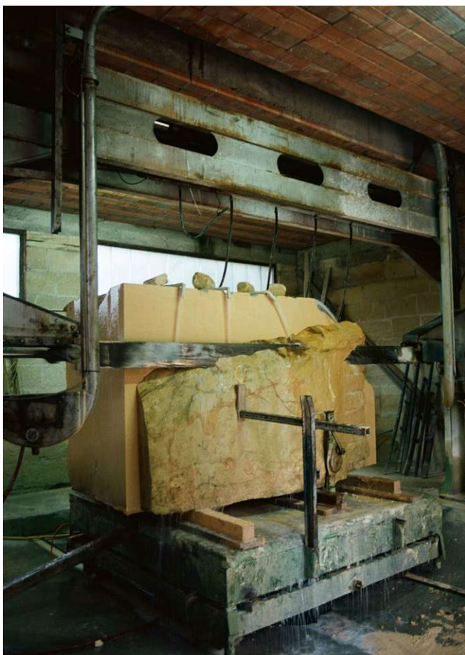
47. Zerteilung eines Rohblocks in Platten mittels der Gattersäge
