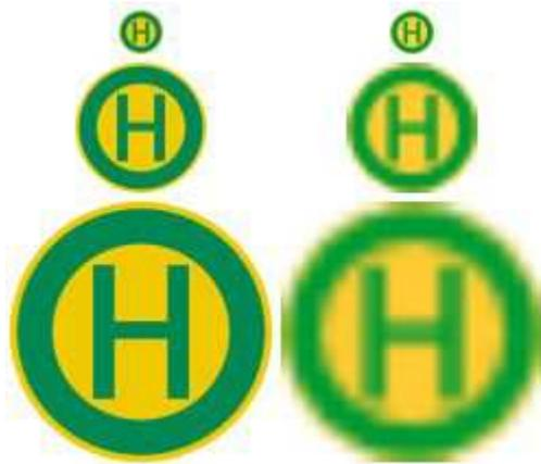
Abb. 7: Vergleich der Skalierung von Vektorgrafik (links) und Rastergrafik (rechts)
