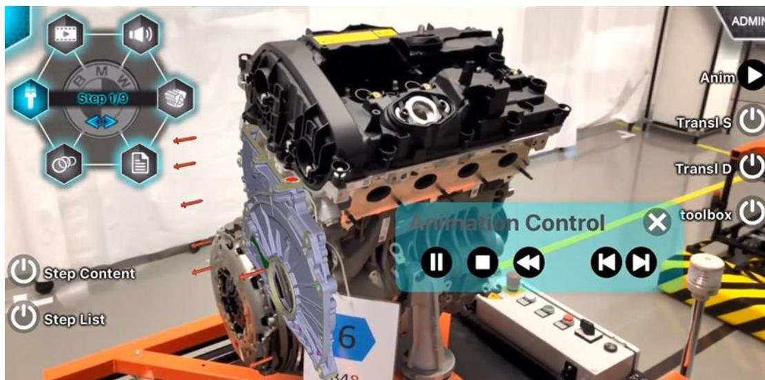
**Abbildung 78: UI auf dem Endgerät mit Einblendung einer Animation; Rechts: Öffnung des Administrator Modus für die virtuelle Registrierung und Abspielen der Animation (Quelle: Workshop Anbieter D)**
