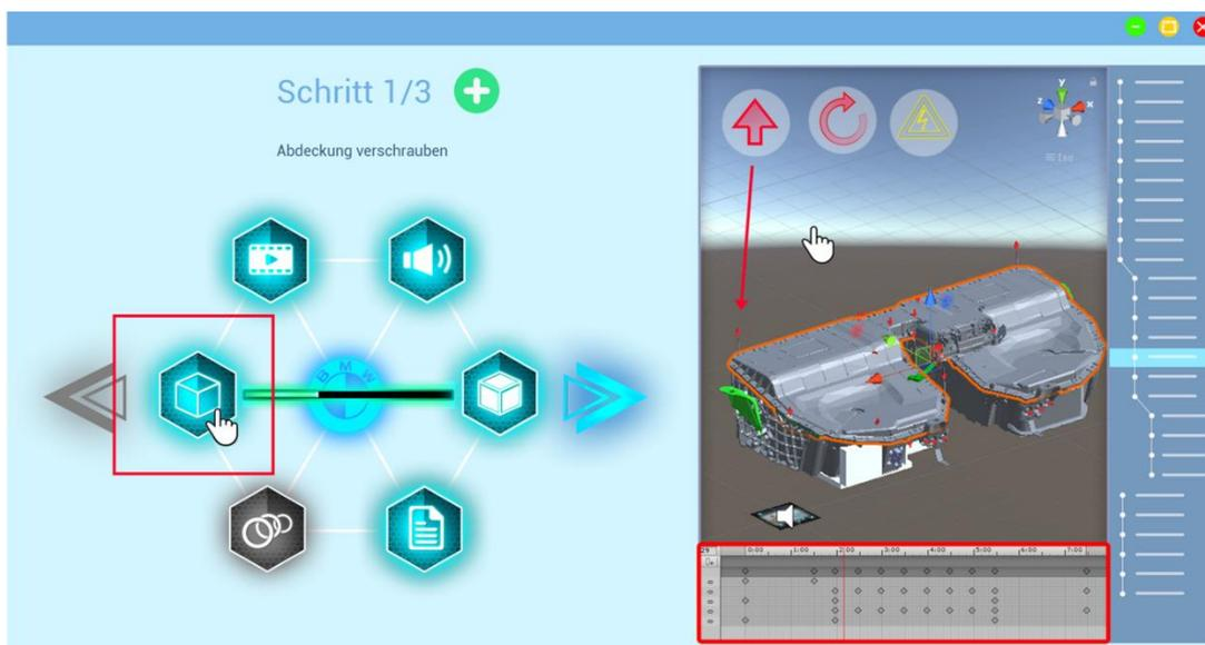
**Abbildung 57: Generierung einer Animation in dem Autorenprogramm mit Einblendung einer Animationspalette und Timeline (Nguyen 2018)**
