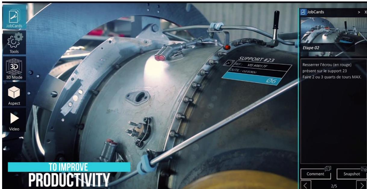
Abbildung 64: UI des Anbieter A Players auf dem Tablet; Rechts sind die Job Cards abgebildet, links werden zusätzliche Funktionen, wie zum Beispiel der Tracking Anlernmodus dargestellt (ANBIETER A 2018)
