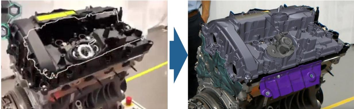
**Abbildung 77: Model-based Tracking - links: Tracking Modell nicht gefunden, rechts: Tracking-Modell gefunden (Quelle: Workshop Anbieter D)**
