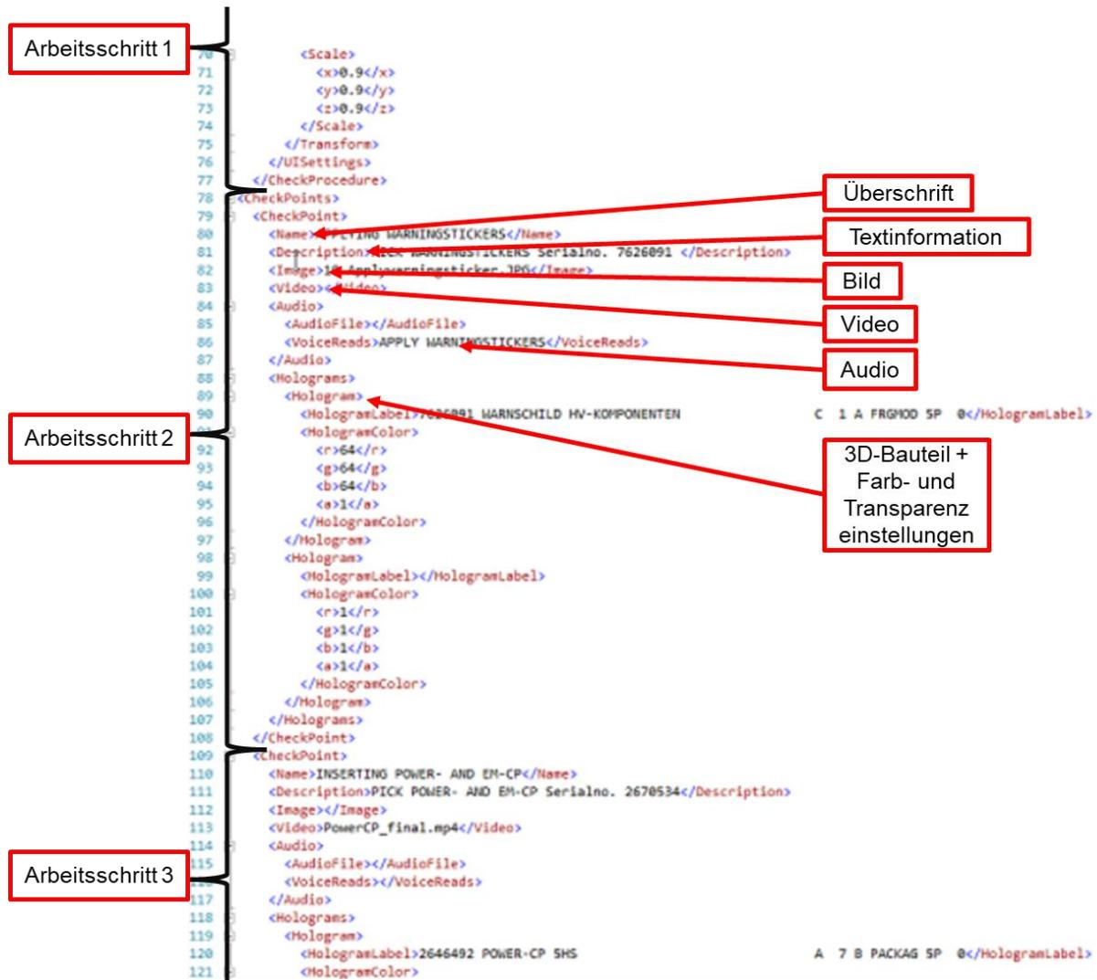
Abbildung 112: Workflow-Erstellung: Content-Verlinkung innerhalb eines Arbeitsschrittes mit XML-Code in Visual Studio (Screenshot Visual Studio)
