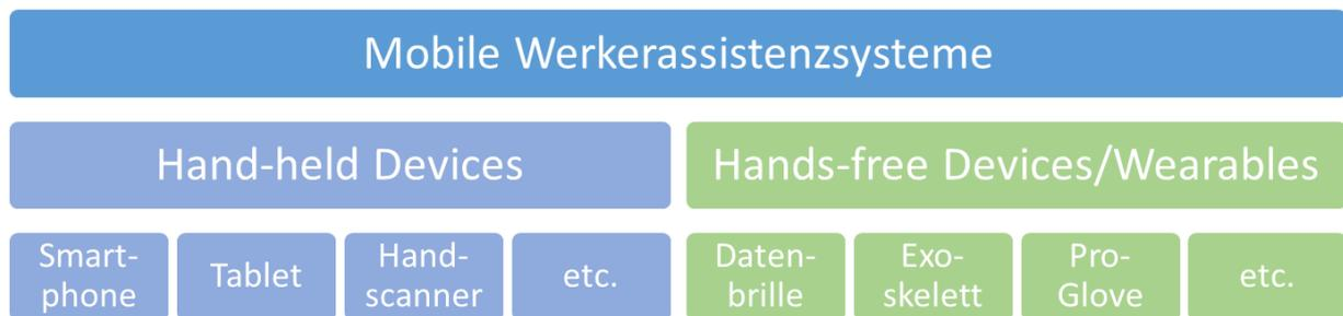
**Abbildung 29: Übersicht mobiler Werkerassistenzsysteme**
