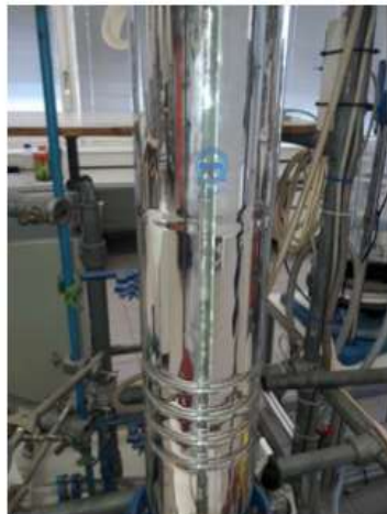
Abbildung 6: Kolonne mit Vakuummantel und Verspiegelung
