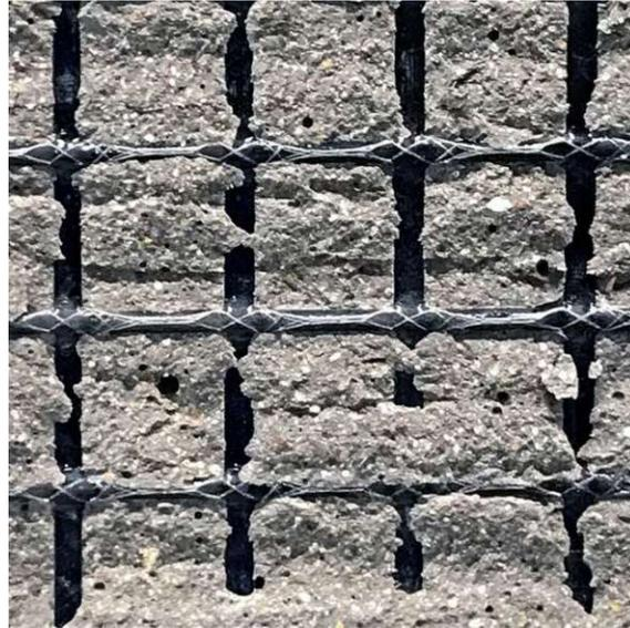
**Abb. 2.13:** In Feinbeton eingebettete Textilbewehrung aus Carbon
