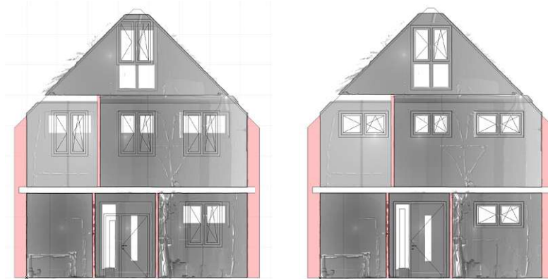
Abb. 5.67: Anpassung der Fensterformate und -teilungen in einem Schnitt mit spezieller Schnitttiefe.
