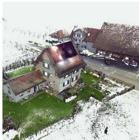
Abb. 2.3: Erzeugte Punktwolke eines TLS-Scanner (Roger Lustenberger, 2022)
