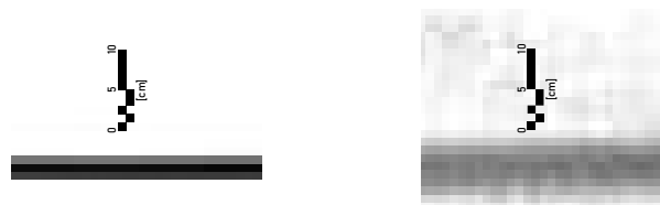
Abb. 4.13: Vergleich des Rauschverhaltens von TLS- (links) und SLAM-Punktwolken (rechts)
