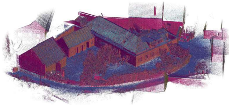
Abb. 4.3: Visualisierung einer SLAM-Punktwolke (GeoSlam-ZEBRevoRT)
