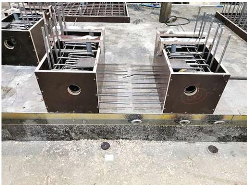
(a) Fertigteillisenen: Herstellen der Lisenen
