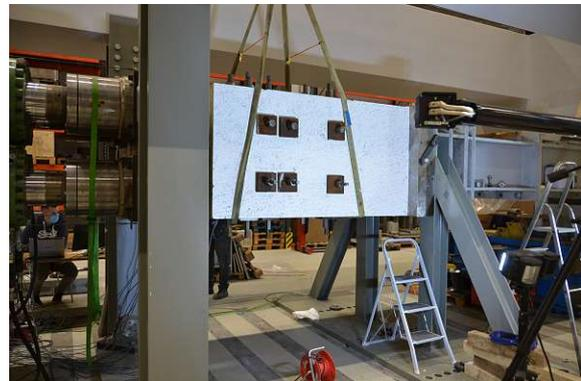
(b) links: Pressen / rechts: Widerlagerkonstruktion
