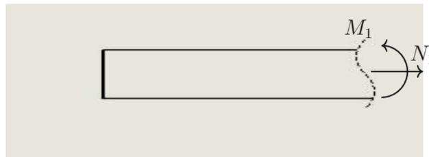
Abbildung 27: Erster Schnitt: Vom Wellenende bis zum Lager B mit einer gültigen Länge von  $0\text{mm} < x < 81,3\text{mm}$
