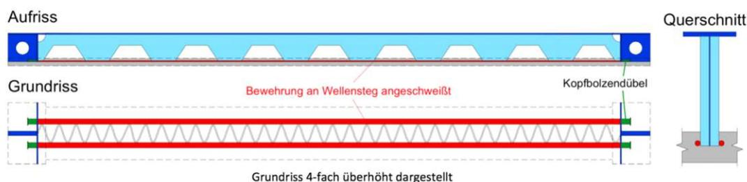
**Abb. 1.7:** Wellstegträger im Verbund mit dem Halbfertigteil, entnommen aus [3] © G.S. Wittmann
