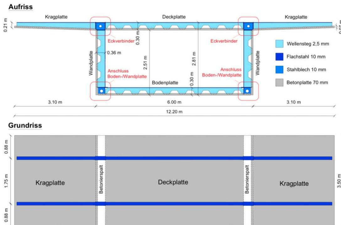
Abb. 1.6: zusammengesetztes Segment der Stahlvariante, entnommen aus [3] © G.S. Wittmann
