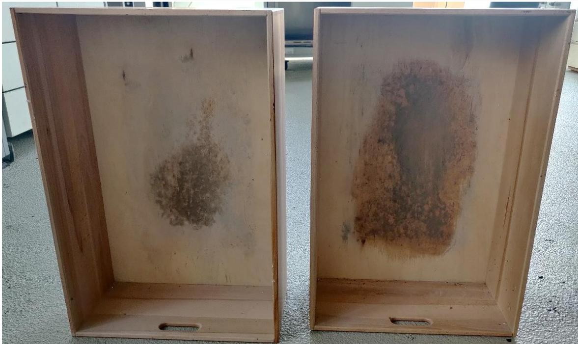
Abbildung 4-4 Vergleich Wasserrückstand im Prüfstand nach 17h-Zyklus (links: PA 8, rechts: AC 11)
