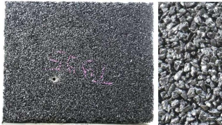
Abbildung 3-2 Massenanteile Platte und Dokumentation: PA 4 20/30, nicht sandgestrahlt
