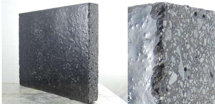
Abbildung 3-10 Massenanteile Platte und Dokumentation: MA 8 20/30, nicht sandgestraht
