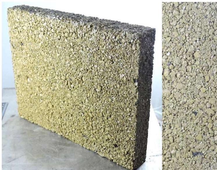
Abbildung 3-9 Massenanteile Platte und Dokumentation: AC 8 synthetisch transparentes Bindemittel mit gelbem Farbpigment, nicht sandgestrahlt
