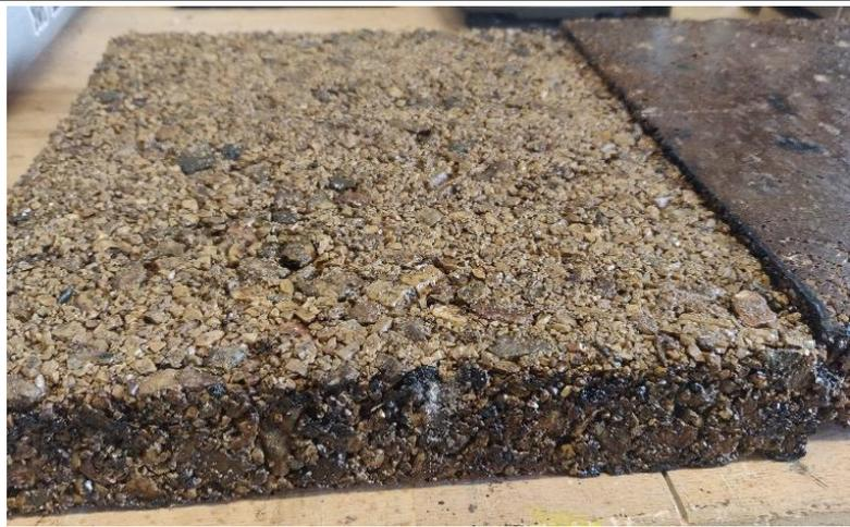
Abbildung 3-8 Massenanteile Platte und Dokumentation: AC 11 mit synthetisch transparentem Bindemittel, nicht sandgestrahlt
