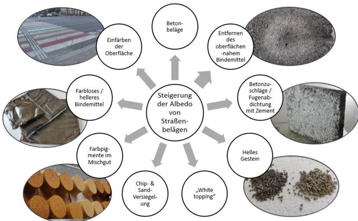
Abbildung 2-2 Möglichkeiten zur Steigerung des Albedo-Wertes
