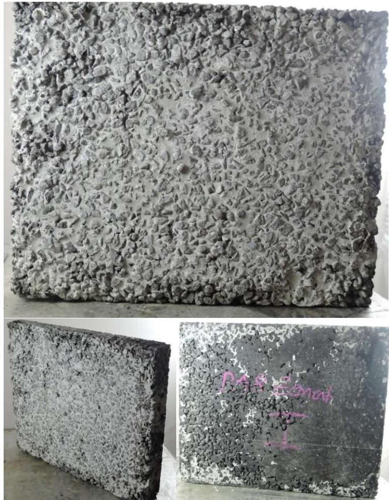
Abbildung 3-5 Massenanteile Platte und Dokumentation: HSD 8, sandgestrahlt
