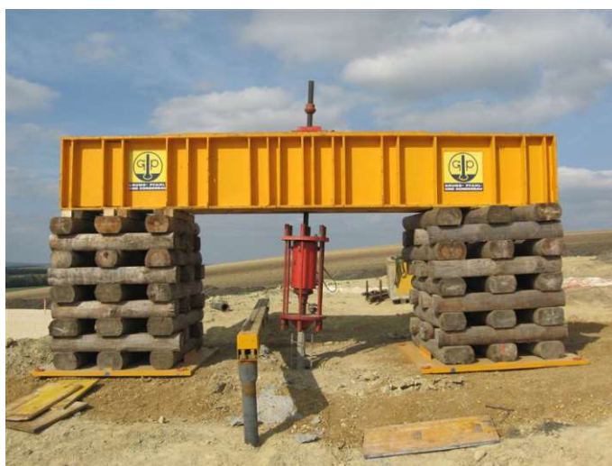
Abb. 4.22: Aufbau des Pile HAY-Proof-System ® -Zugversuchs des Projektstandorts HA3 in Hagen (Foto: KELLER GRUNDBAU GES.MBH.)
