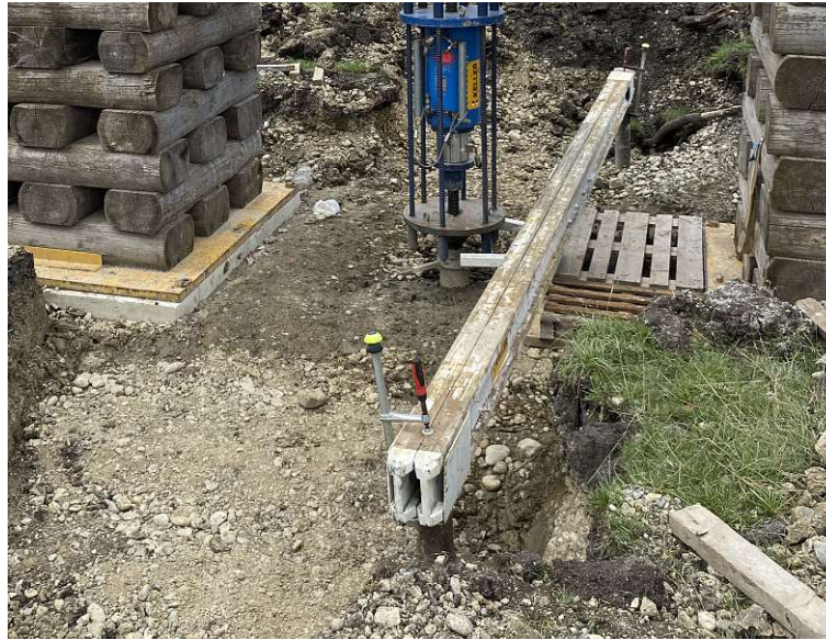
Abb. 2.11: Messträger aus Holz beim statischen Zugprobeversuch
