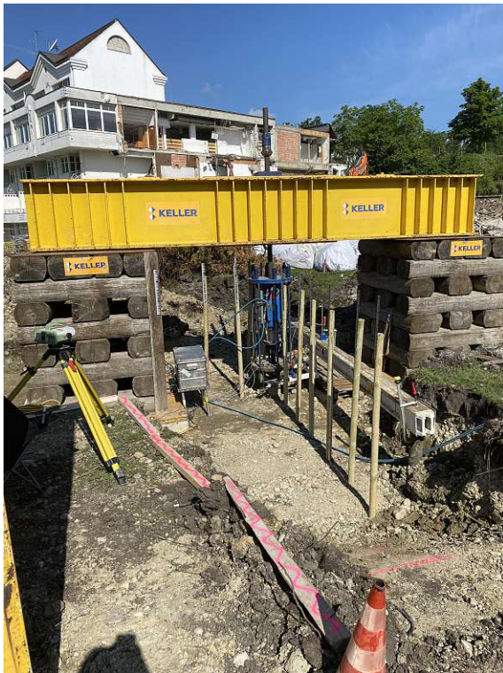
(a) Versuchsaufbau des Prüfpfahls mit den Holzpflocken
