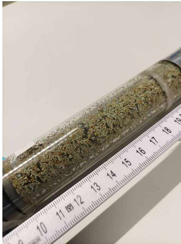
Abb. 3.9: Säule des Versuchs IV-A-01 nach Ausbau, „Riff-Struktur“ erkennbar
