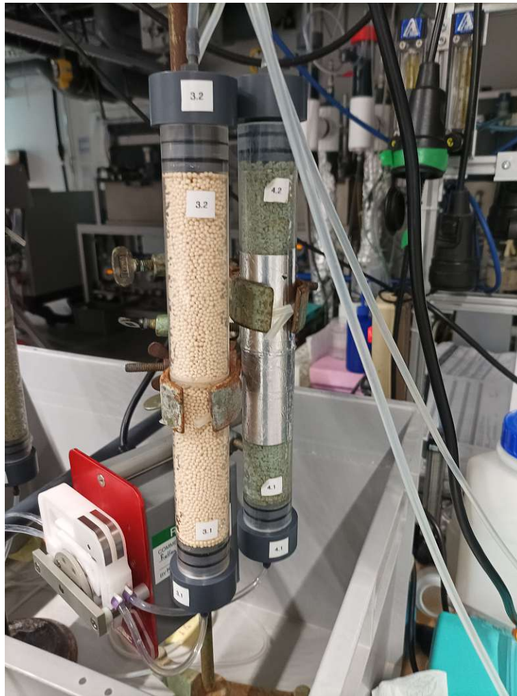
Abb. 3.7: Versuchsaufbau für Säule 03+04, inkl. Schlauchpumpe und Pumpschläuche, Füllmaterialien: im Vordergrund, links KÖSTROLITH® , im Hintergrund, rechts CLP58+
