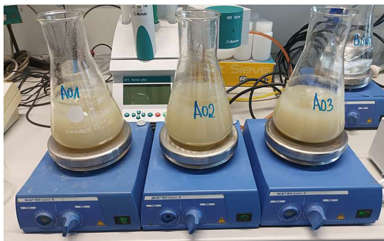
Abb. 3.3: Versuch mittels Magnetrührer, Trübung nach 24h, Probenreihe A
