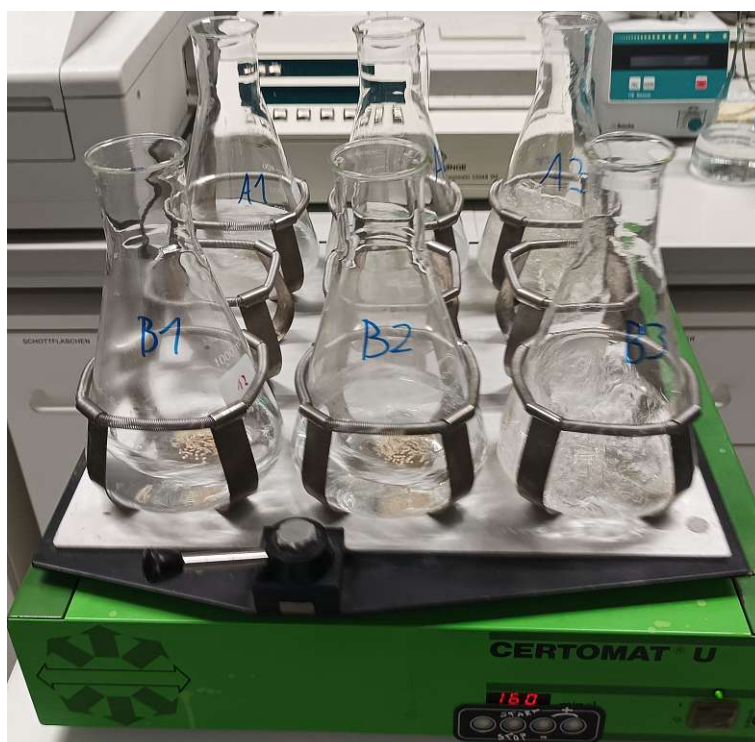
Abb. 3.5: Schüttelversuch am Rotator, Probentriplikate A und B, Spezialkolben rechts außen
