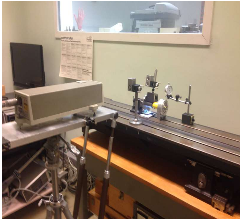
Abbildung 7.39 Aufbau für die Messungen mit dem Laserinterferometersystem
