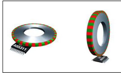
Abbildung 7.33 AS5311 mit mehrpoligen Ringmagneten zur Erfassung der Drehbewegung [68]
