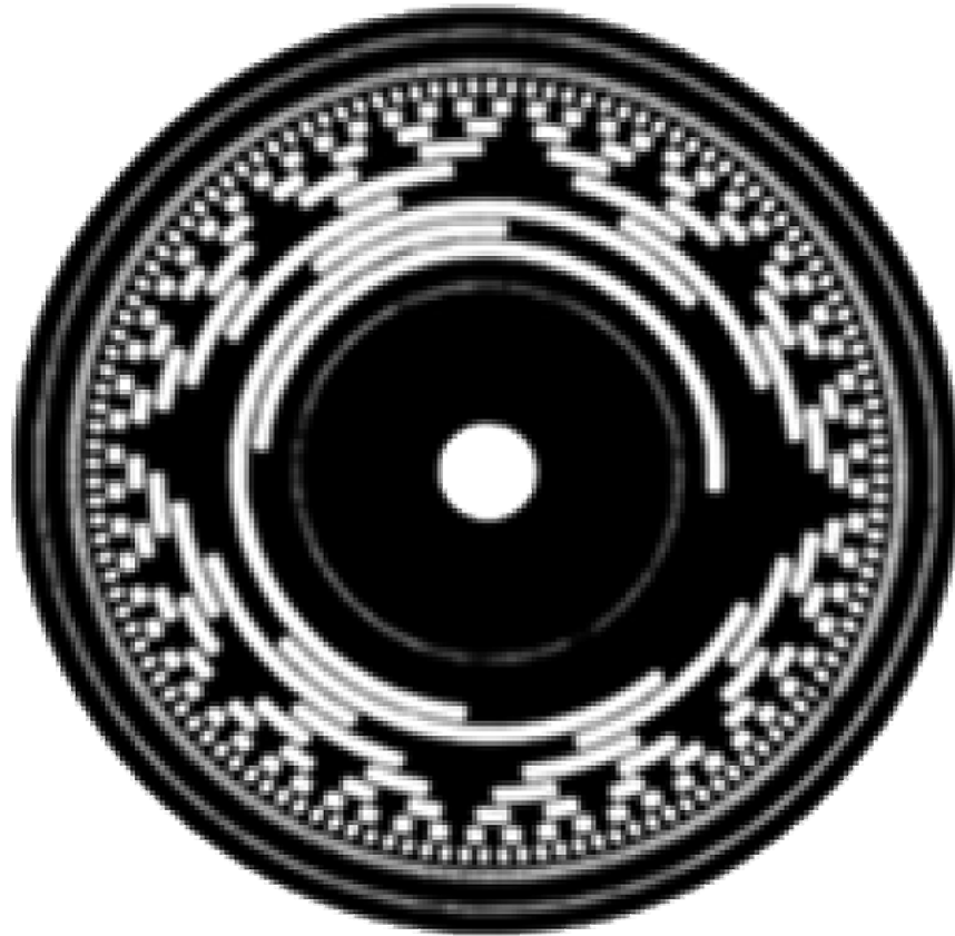
Abbildung 5.22 Absolute Drehwertgeberscheibe mit konzentrischem Kreismuster [63]
