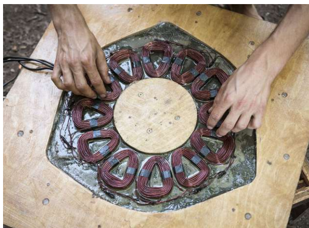
Abbildung 8: Herstellung des Stators des Generators [58]
