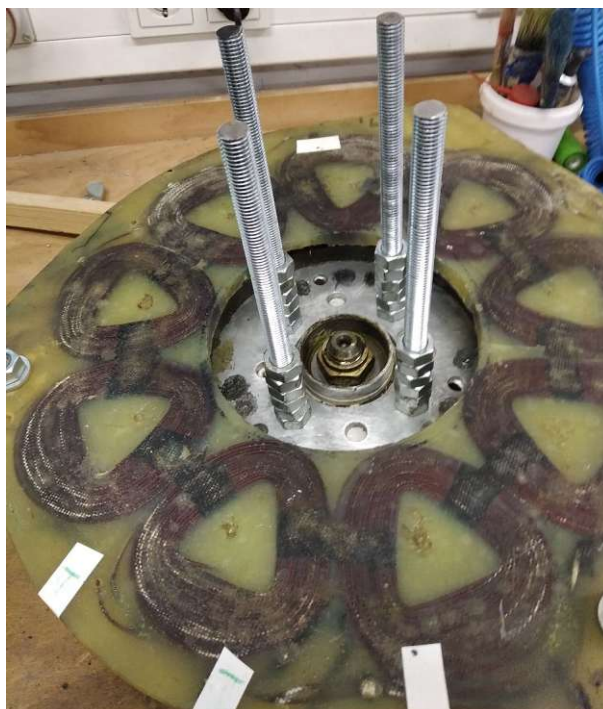
Abbildung 17: Blick auf den Stator mit rostroten Spulen und das Lager der APSM ohne vordere Rotor-scheibe und Lagerschutzklappe
