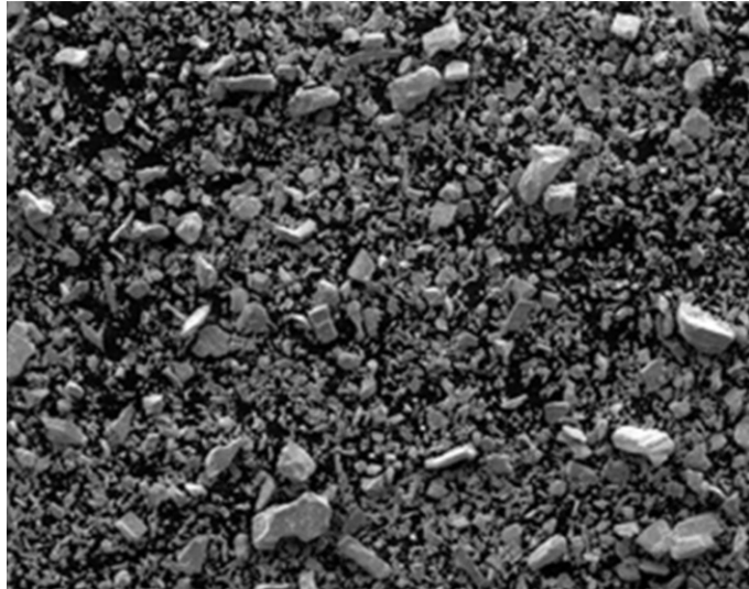
Abbildung 23: REM-Aufnahme des Tribotecc- BIS83 Pulvers [78]
