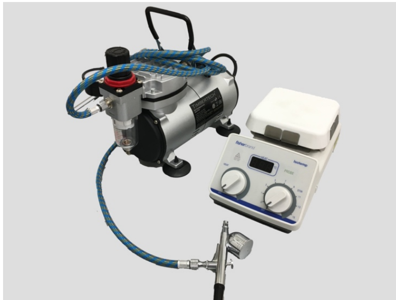
Abbildung 27: Beschichtungssetup des Airbrush-Verfahrens bestehend aus Kompressor, Pistole und Heizplatte
