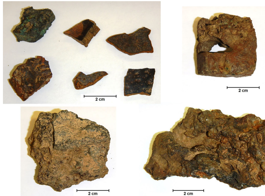
Abb. 2: Schlackenproben (a, b) und ein angeschlacktes Ofenlehmfragment (c) vom Kupferschmelzplatz Rehfüterung/Spitalgraben, sowie eine blasige Schlacke (d) vom Schlackenfundplatz Schreiebach-Dreizipfgraben
