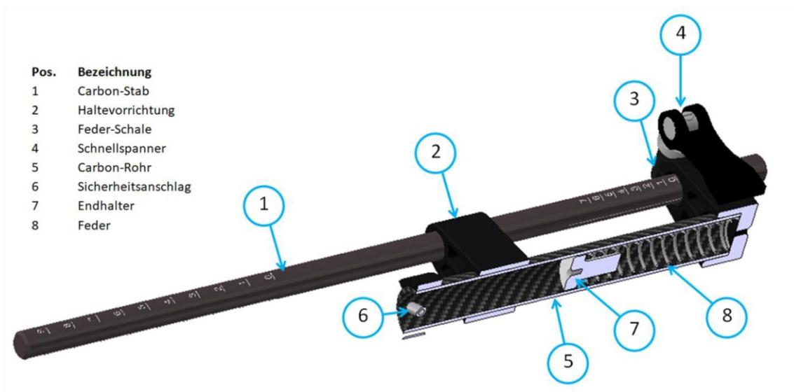
Abbildung 56: Unterarm-Gewichtskompensations-Modul – CAD-Modell.
