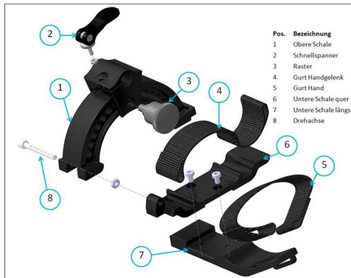
Abbildung 58: Handgelenks-Modul – Explosionszeichnung.
