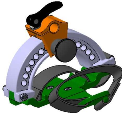
Abbildung 57: Handgelenks-Modul – CAD-Modell.
