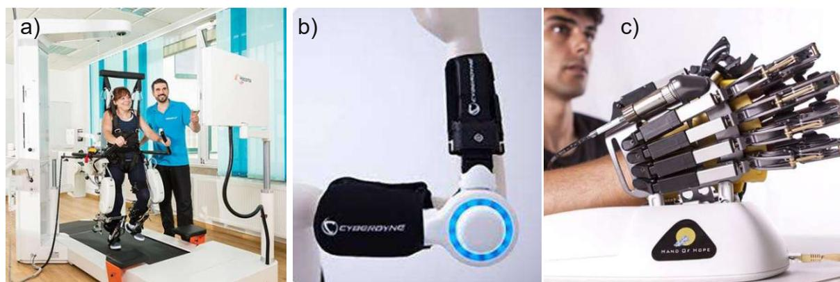
**Abbildung 2: Ausgewählte Exoskelette für die Rehabilitation der: a) unteren Extremität (Lokomat®), b) oberen Extremität (HAL Single Joint Type) und c) der Hand (Hand of Hope) [18].**
