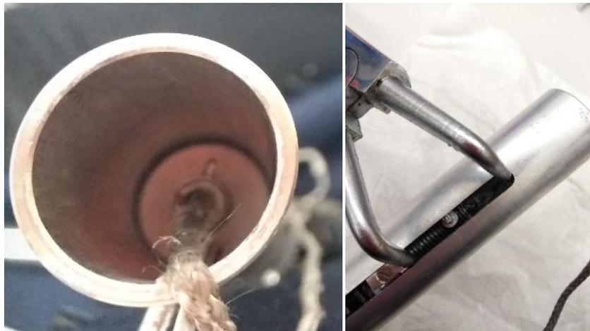
**Abbildung 62: Seilbefestigung im Gewichtskompensations-Modul**
