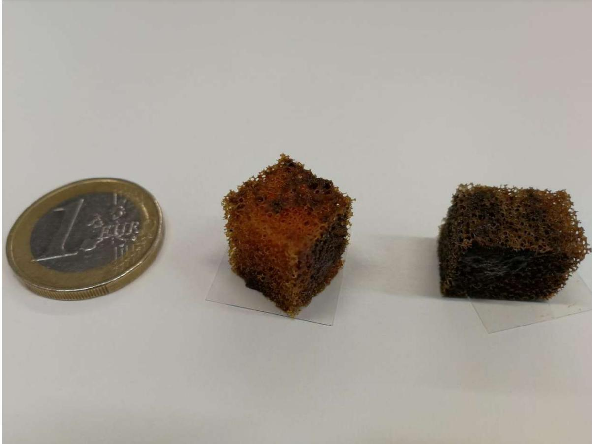
*Abb. 5: Zwei Linpor® Polyurethanwürfel (Entnahme an Tag 103 (links) und 219 (rechts)) mit einer Münze als Größenvergleich*
