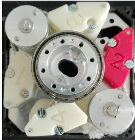
(b) qb move advanced Federsystem und Servomotoren.
