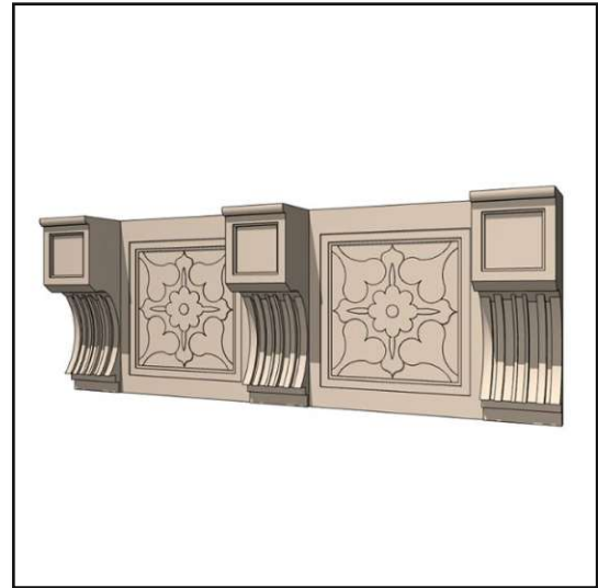
Abb. 88.: Ornamente der Dachgesimse Kopfgebäude, Modelldarstellung
