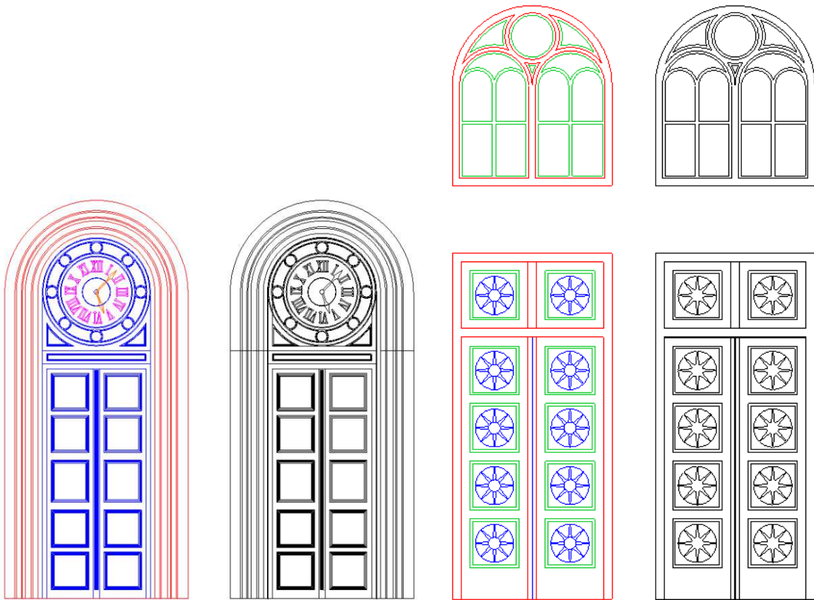
Abb. 99.: links - zweidimensionale und dreidimensionale Rekonstruktion der Haupteingangstür des Vestibüls der Abfahrtseite und der Ankunftsseite, EG, Modelldarstellung
