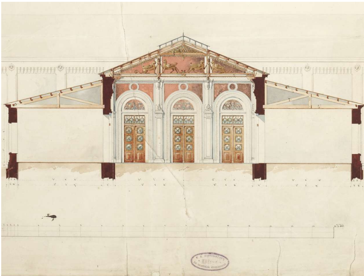
Abb. 133.: Wiener Westbahnhof, Aufnahmsgebäude der Kaiserin Elisabeth-Bahn in Wien, Ankunftsseite, Querschnitt durch das Vestibül, Kolorierte Tuschzeichnung aus dem Jahr 1856, Blatt 15, von Loehr, Patzelt, Unger, Herrman und anderen.
