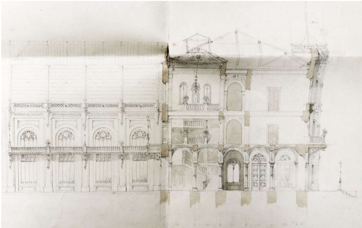
Abb. 40.: Wien Westbahnhof, Schnitt durch das Kopfgebäude
