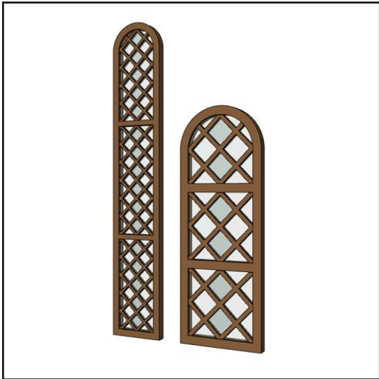
Abb. 111.: Fenster Personenhalle, 1.OG und 3.OG Turmanbau, Modelldarstellung
