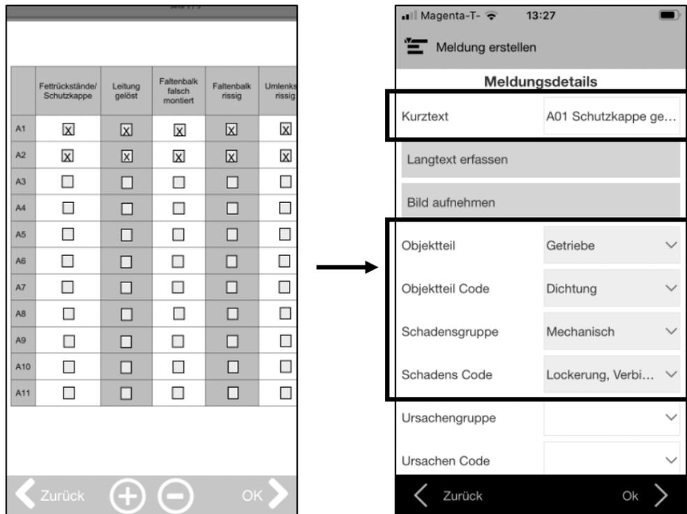
Abbildung 52: Automatische Generierung der Wartungsnachmeldung<sup>238</sup>
