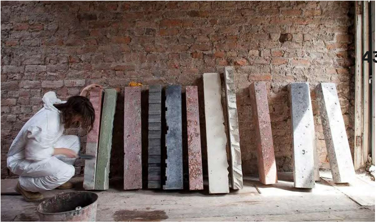
A.28 Aus Bauschutt werden im Granby Workshop neue Bauteile für das Quartier erzeugt (granbyworkshop.co.uk)
